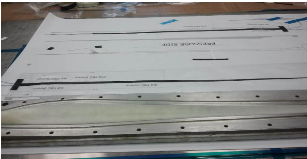
Figura 4.9 Processo di laminazione
