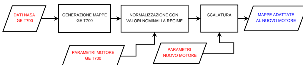
Figura 3.10: Diagramma di flusso per il processo di generazione e adattamento delle mappe delle turbomacchine.
