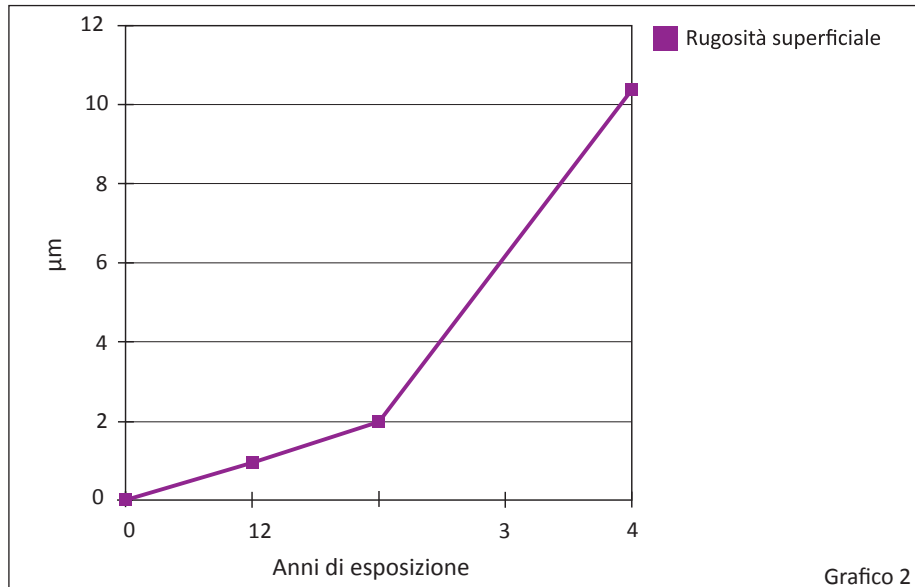
Grafico 2. Cambiamenti di rugosità superficiale di un campione in ABS. Natural weathering, 5 anni di esposizione. Fonte: Kogyo Kaihatsu Shikensho Hokoku . Op. Cit.
