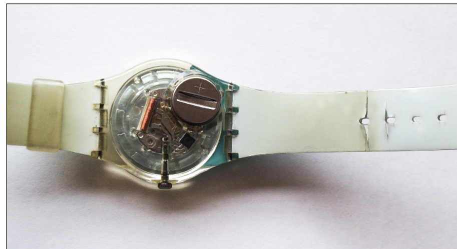
Immagine 16. Ingiallimento e fessurazioni su cinturino in materiale polimerico dovuto a processi di weathering.
