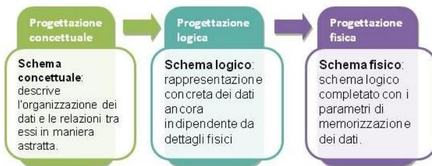
*Figura 1.2 - Le tre fasi della progettazione di un database.*
