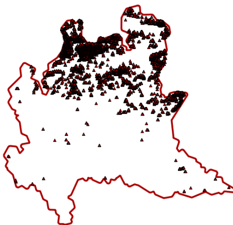
Figura 2.15: Rappresentazione dei 'nodata' contenuti nella versione 2 del GDEM SRTM per il territorio della Lombardia
