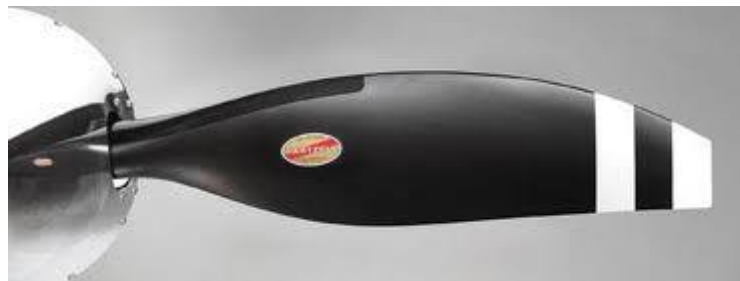
Figura 1. Esempio di componente aeronautico realizzato in RTM.
