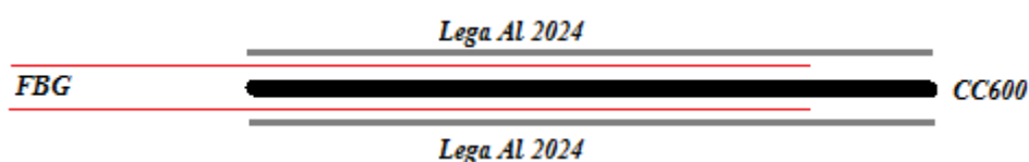
Figura 27. Posizione FBG nell'ibrido a "sandwich"
