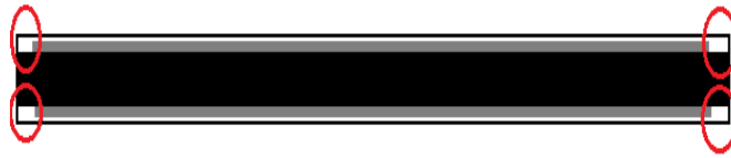
Figura 29. Sezione del "sandwich" ibrido e presenza di percorsi preferenziali.
