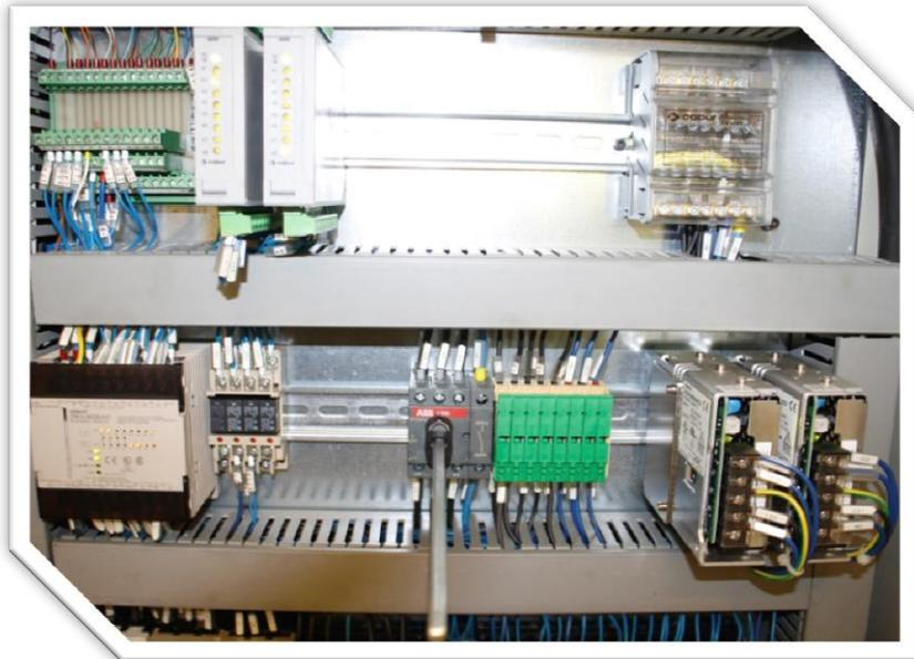
Figura 31 - Cabina bordo centro di lavoro - Morsettiere per l'interfacciamento esterno
