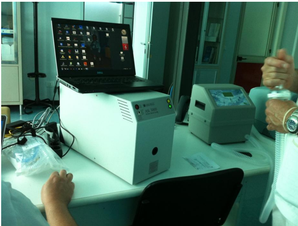
Figura20 - Collegamento Cough Assist ad ASL5000. Il tubo sulla destra collegato al cough assist, sta per essere messo nella sede del ASL5000
