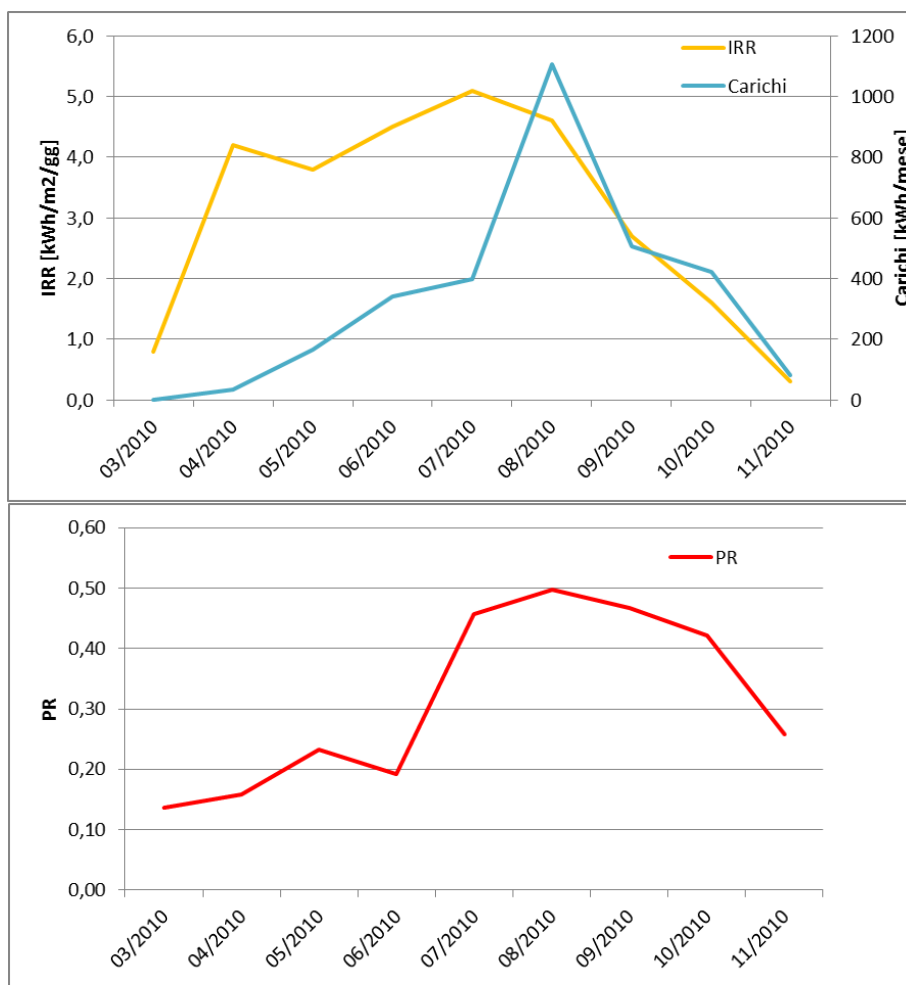
Figura 4-9: andamento di irraggiamento, carichi elettrici e PR durante il 2010
