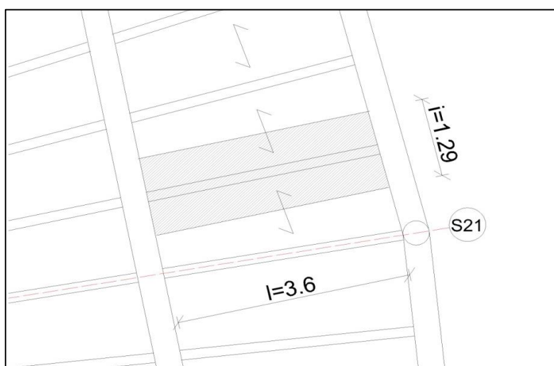
Fig. 5.5 – Area d'influenza travi secondarie P1
