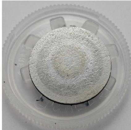
Figura 4.16: Foto del campione composto dal film dopo l'esposizione al plasma ad alta temperatura: è possibile osservare la presenza di tre anelli di diverso colore, a seconda del tipo di impurezze.
