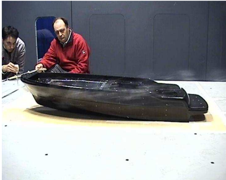
Figura 3.27- Visualizzazione di fumo. \tau=2,0^\circ H=40,00 mm. SENZA SOVRASTRUTTURA.
