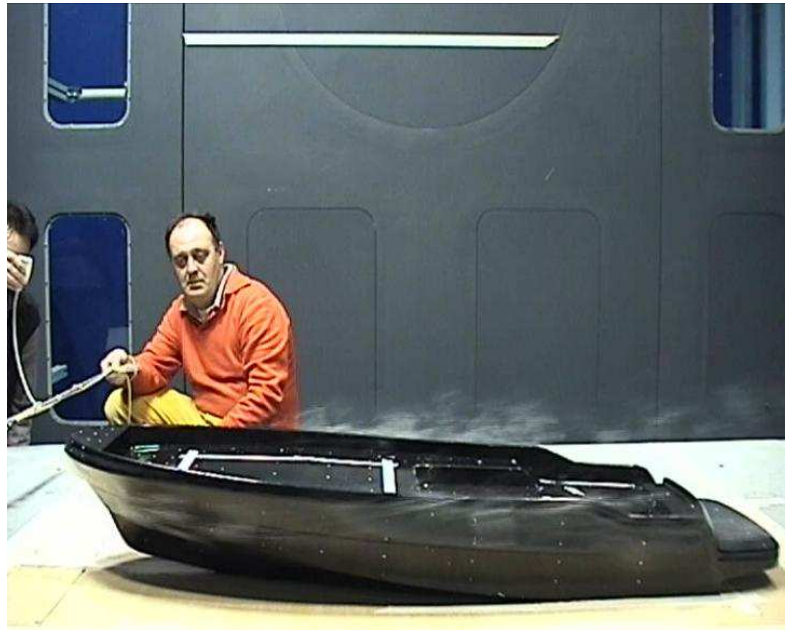
Figura 3.32 - Visualizzazione di fumo. \tau=2,9^\circ H=30,19 mm. SENZA SOVRASTRUTTURA.
