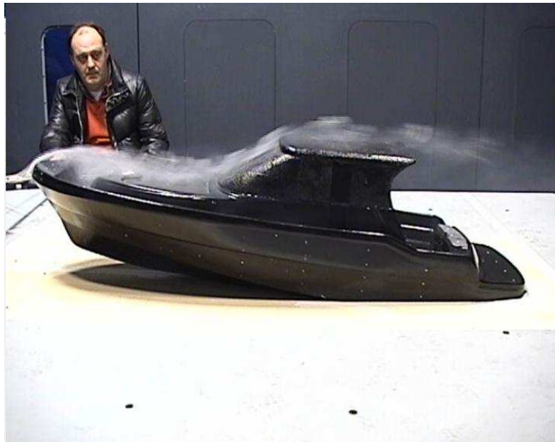
Figura 3.64 – Visualizzazione di fumo. \tau=6,0^\circ H=20,00 mm. CON SOVRASTRUTTURA.
