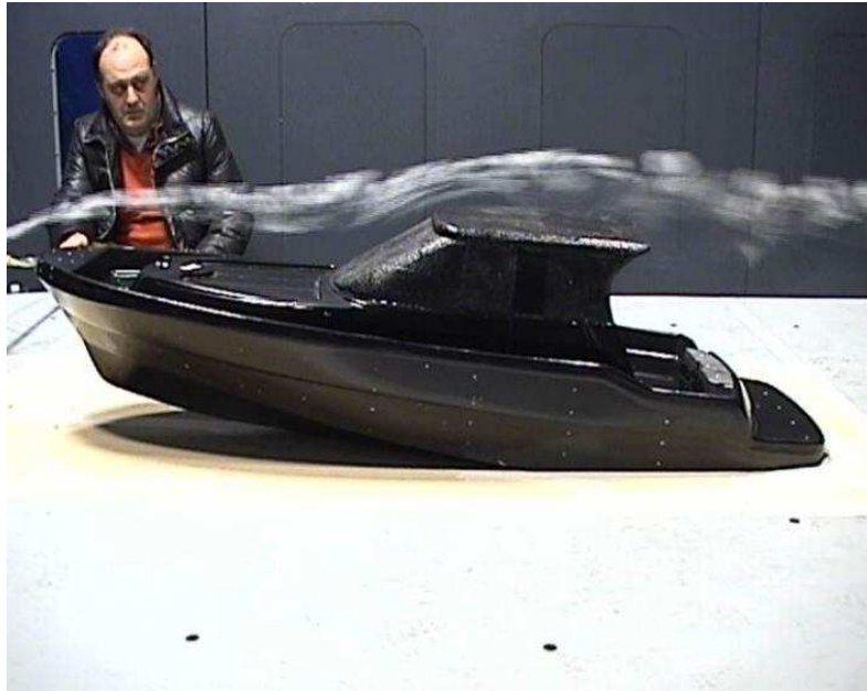
Figura 3.63 – Visualizzazione di fumo. \tau=6,0^\circ H=20,00 mm. CON SOVRASTRUTTURA.
