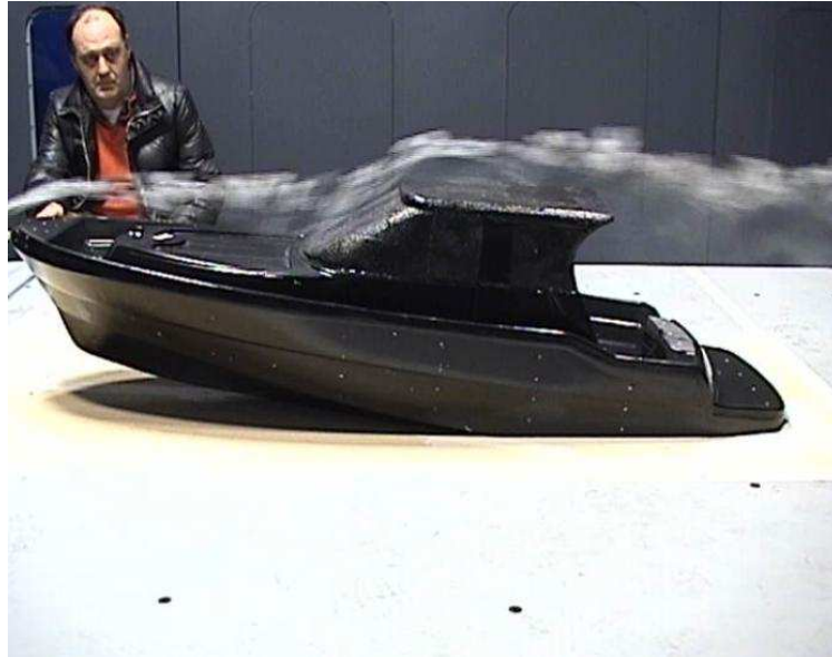
Figura 3.65 – Visualizzazione di fumo. \tau=6,0^\circ H=20,00 mm. CON SOVRASTRUTTURA.
