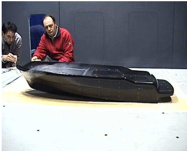
Figura 3.26 - Visualizzazione di fumo. \tau=2,0^\circ H=40,00 mm. SENZA SOVRASTRUTTURA.
