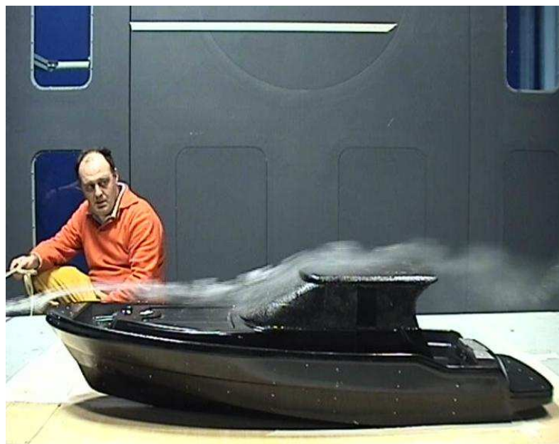
Figura 3.53 – Visualizzazione di fumo. \tau=2,9^\circ H=30,19 mm. CON SOVRASTRUTTURA.
