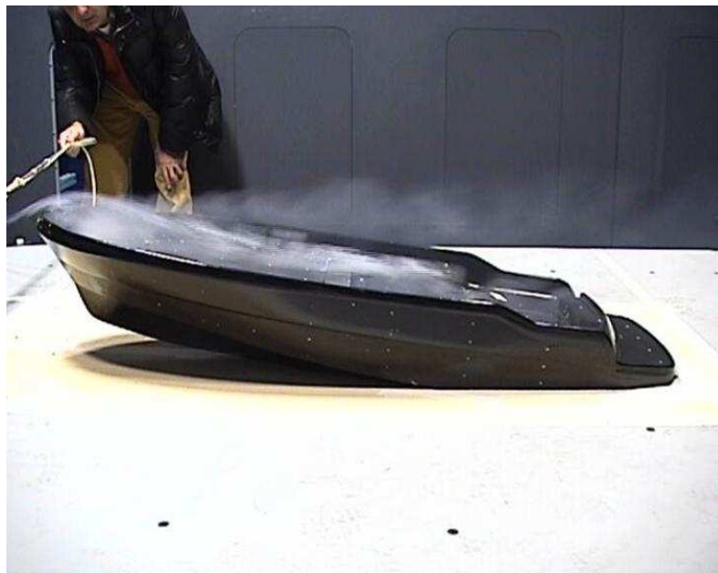
Figura 3.43– Visualizzazione di fumo. \tau=6,0^\circ H=20,00 mm. SENZA SOVRASTRUTTURA.
