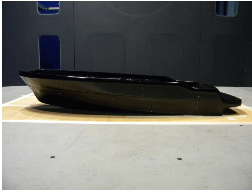
Figura 3.4 - assetto: \tau=2,9^\circ H=30,19 mm, senza sovrastruttura.
