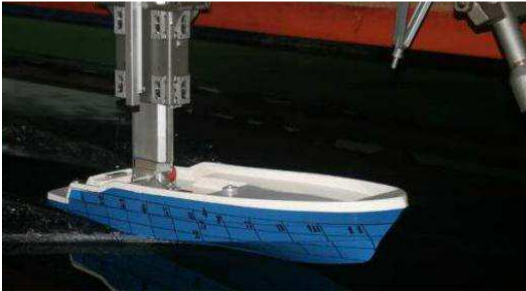
Figura 3.2 - Prova in vasca navale presso l'Università degli Studi di Napoli, V_M=6,06 m/s.
