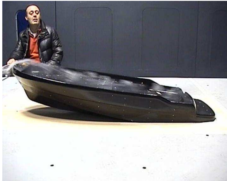
Figura 3.42 – Visualizzazione di fumo. \tau=6,0^\circ H=20,00 mm. SENZA SOVRASTRUTTURA.
