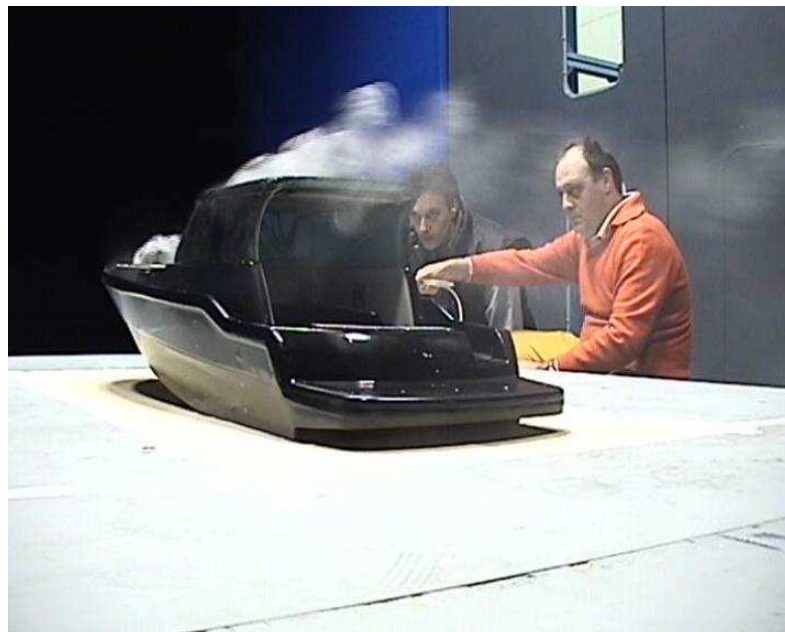
Figura 3.59 – Visualizzazione di fumo. \tau=3,8^\circ H=24,43 mm. CON SOVRASTRUTTURA.
