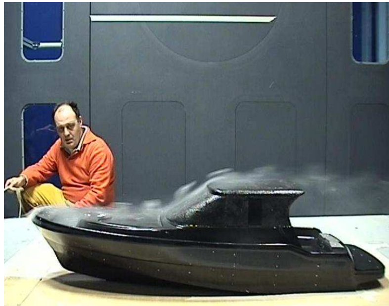
Figura 3.52 – Visualizzazione di fumo. \tau=2,9^\circ H=30,19 mm. CON SOVRASTRUTTURA.
