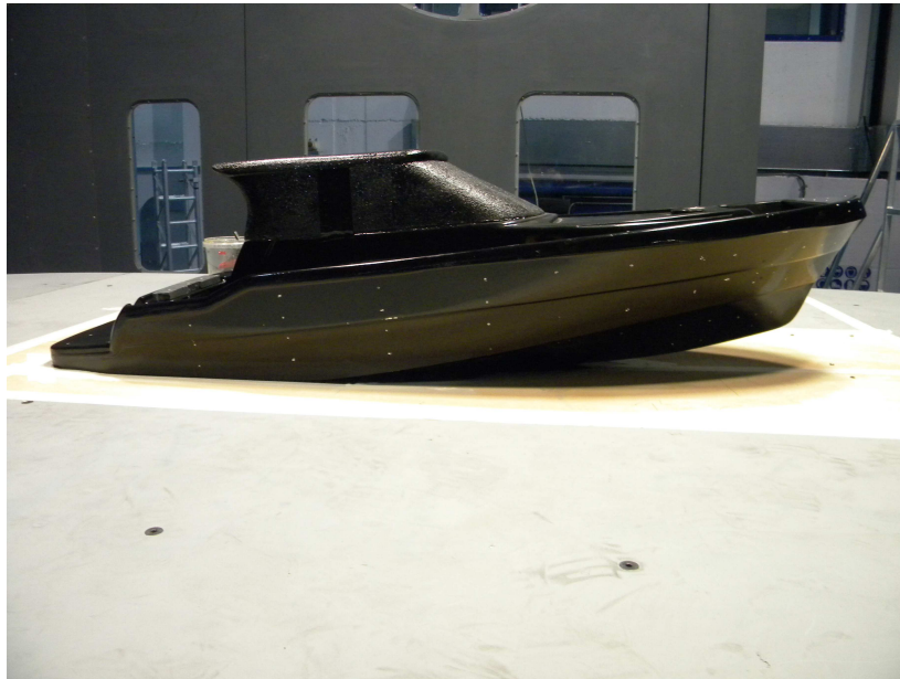
Figura 3.11 - assetto: \tau=6^\circ H=20 mm, con sovrastruttura.
