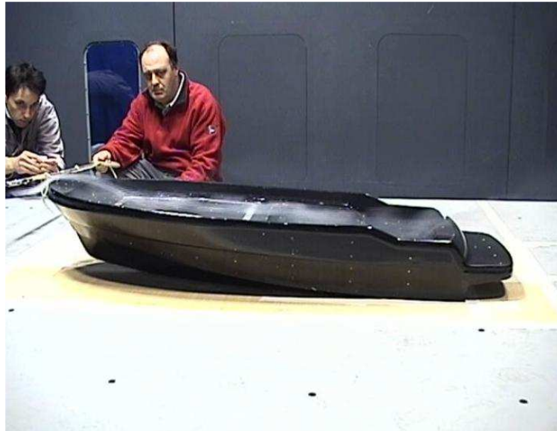
Figura 3.25 – Visualizzazione di fumo. \tau=2,0^\circ H=40,00 mm. SENZA SOVRASTRUTTURA.
