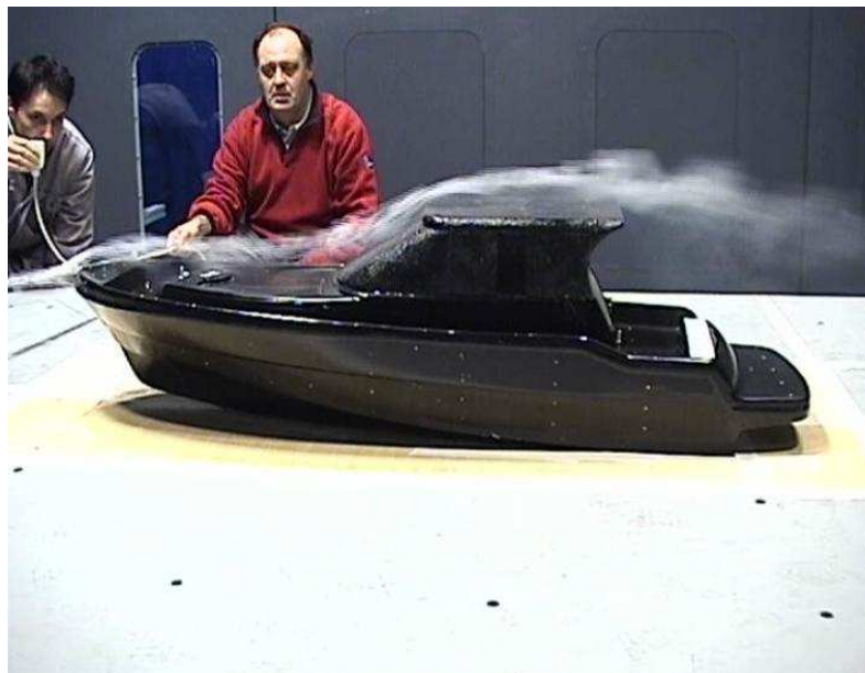
Figura 3.47 – Visualizzazione di fumo. \tau=2,0^\circ H=40,00 mm. CON SOVRASTRUTTURA.
