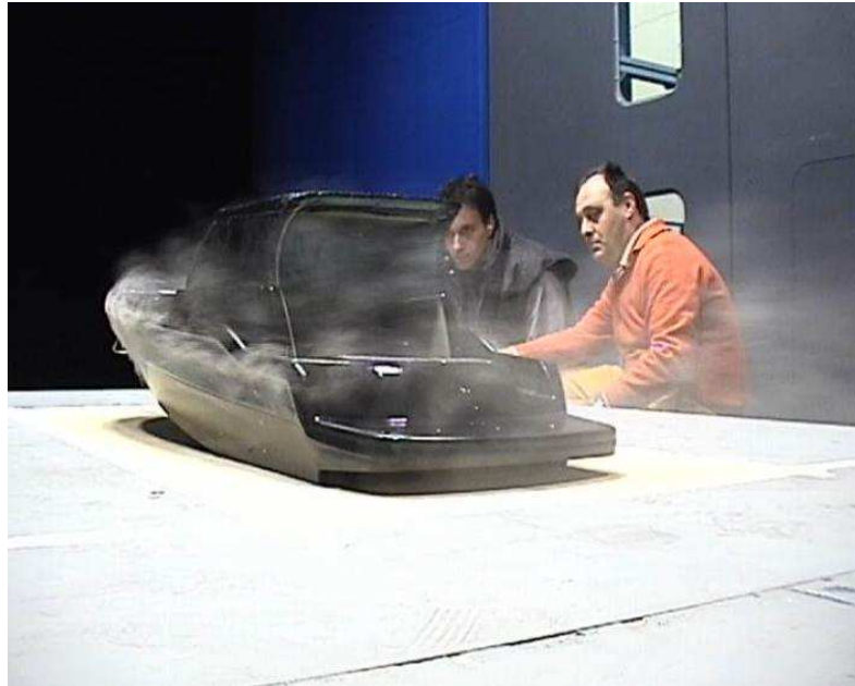
Figura 3.58 – Visualizzazione di fumo. \tau=3,8^\circ H=24,43 mm. CON SOVRASTRUTTURA.
