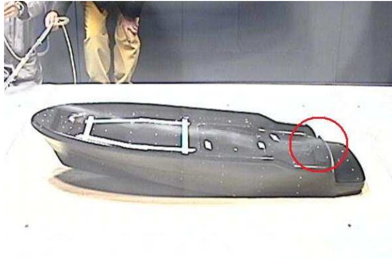
Figura 3.38 - Visualizzazione di fumo. \tau=3,8^\circ H=24,43 mm. SENZA SOVRASTRUTTURA.
