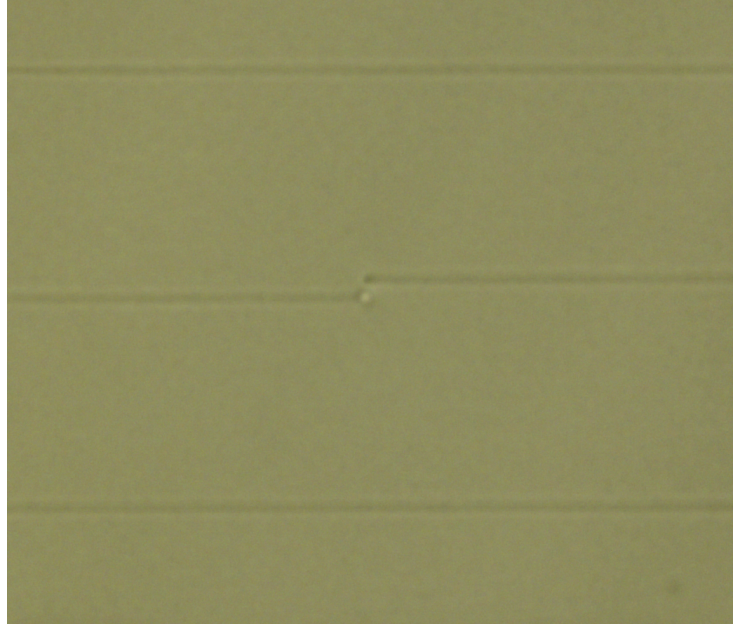
Figura 4.3: Immagine al microscopio ( 20\times ) di un giunto singolo. Sono riportate tre guide. Quella centrale è costituita da il primo tratto (sinistra) con asse ottico a , mentre il secondo tratto (destra) è stato eseguito con la lente in posizione per ottenere 22.5^\circ . Si vede come lo spostamento della lente abbia causato un disallineamento della posizione della guida inclinata rispetto alla guida con asse ottico perpendicolare
