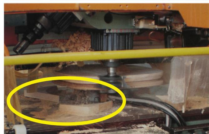
Figura 5.28 Processo di fresatura a 3 assi di un semilavorato in legno e sfridi connessi
