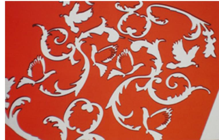
Figura 5.20 Parte utile e sfrido del processo di taglio laser di una lastra di PMMA
