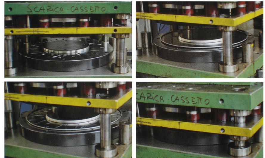
Figura 5.24 Processo di punzonatura in pressa
