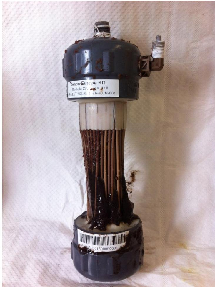
Figura 3.7 Modulo filtrante estratto subito dopo un *TMP-jump*
