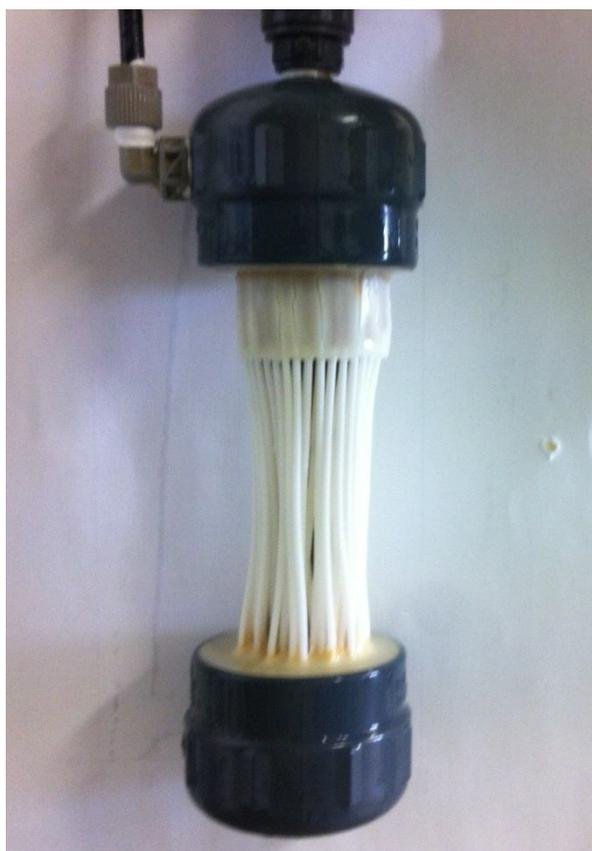
Figura 3.8 Modulo filtrante dopo un lavaggio chimico
