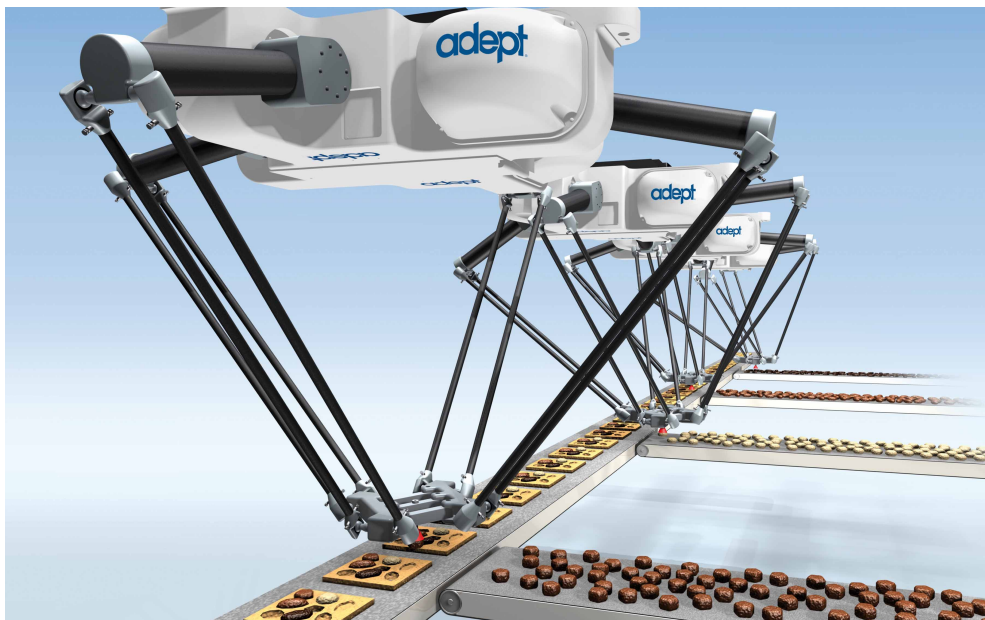
Figura 1.5: Robot Adept quattro, operazioni di Pick & Place
