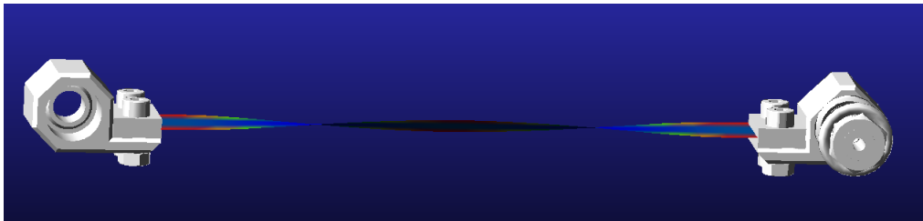
Figura 4.5: Terzo modo di vibrare, f = 954[Hz]
