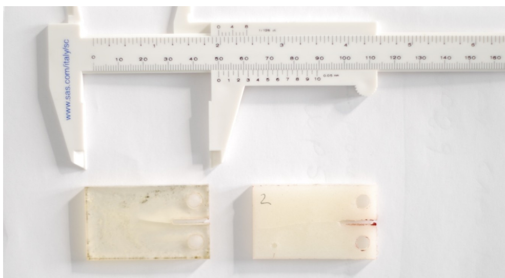
Figura 2.43 Fotografia dei provini utilizzati per la prova a trazione dell'adesivo in bulk.
