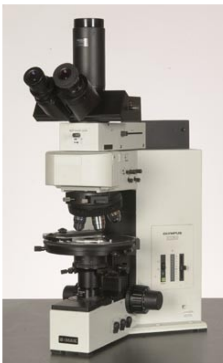
Figura 2.24 Strumento Olympus BX-60 utilizzato per l'acquisizione di immagini al microscopio ottico.
