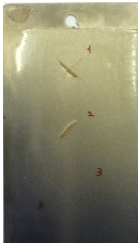
Figura 3.51 Fotografia del provino "bianco", rivestito di sola resina epossidica senza microcapsule. Il campione rappresentato è stato tenuto in forno a 50 °C per sette giorni e in soluzione di NaCl al 10% per altri sette giorni.
