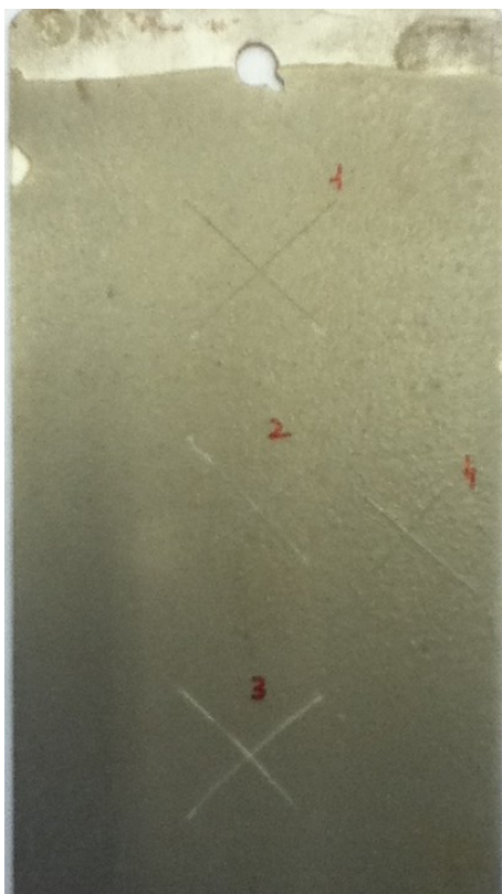
Figura 3.50 Fotografia del provino rivestito di resina epossidica con microcapsule di isocianato-silano. Il campione rappresentato è stato tenuto in forno a 50 °C per sette giorni e in soluzione di NaCl al 10% per altri sette giorni.
