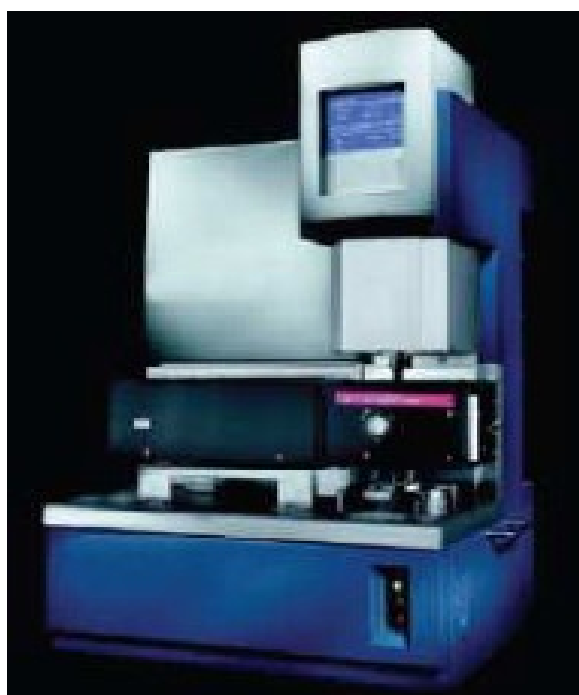
Figura 2.25 Strumento TA Instruments Rheometer Series RSA III utilizzato per le prove di compressione sulle singole microcapsule.
