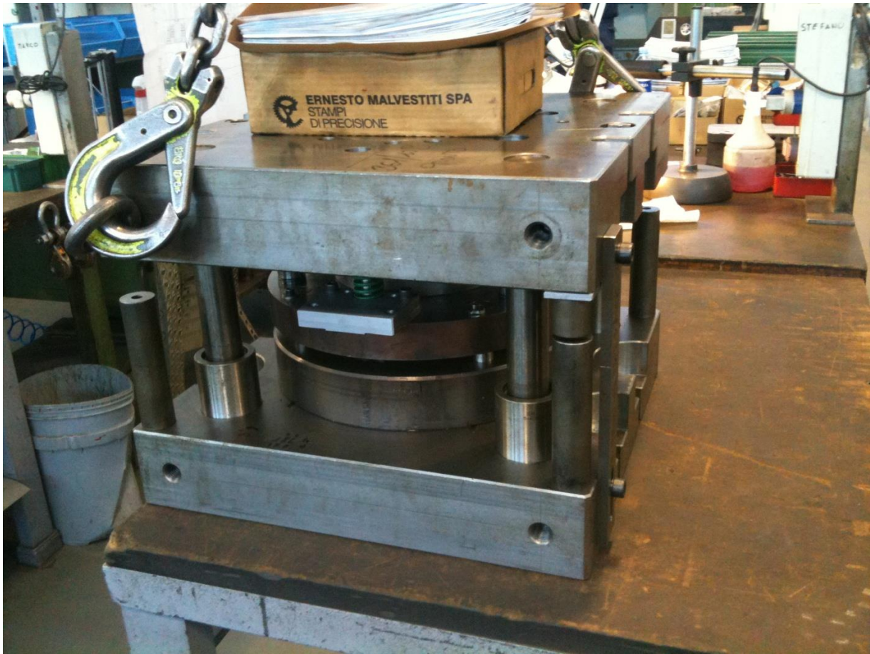
Figura 48 Stampo chiuso pronto per essere trasferito nella sede di Muggiò dove verrà utilizzato sulla pressa per eseguire la campagna di sperimentazione.
