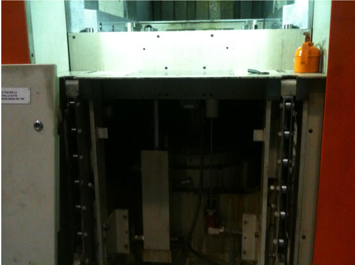
Figura 84 Ubicazione del cilindro principale e di uno dei cilindri di corsa rapida.
