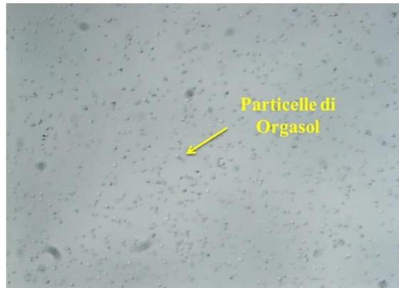
**Figura 3.1** Immagine al microscopio ottico della composizione del fluido particolato
