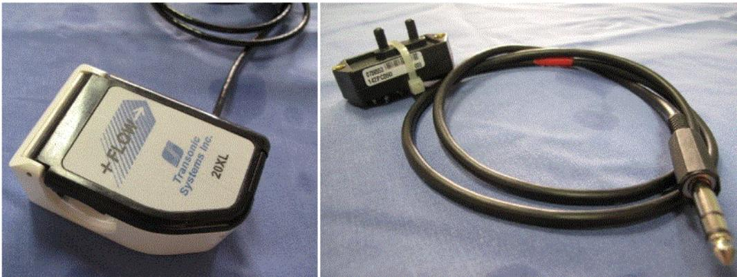
**Figura 2.18** Sonda da 1" del flussimetro a tempo di transito, a sinistra. Immagine a destra trasduttore di pressione piezoresistivo.
