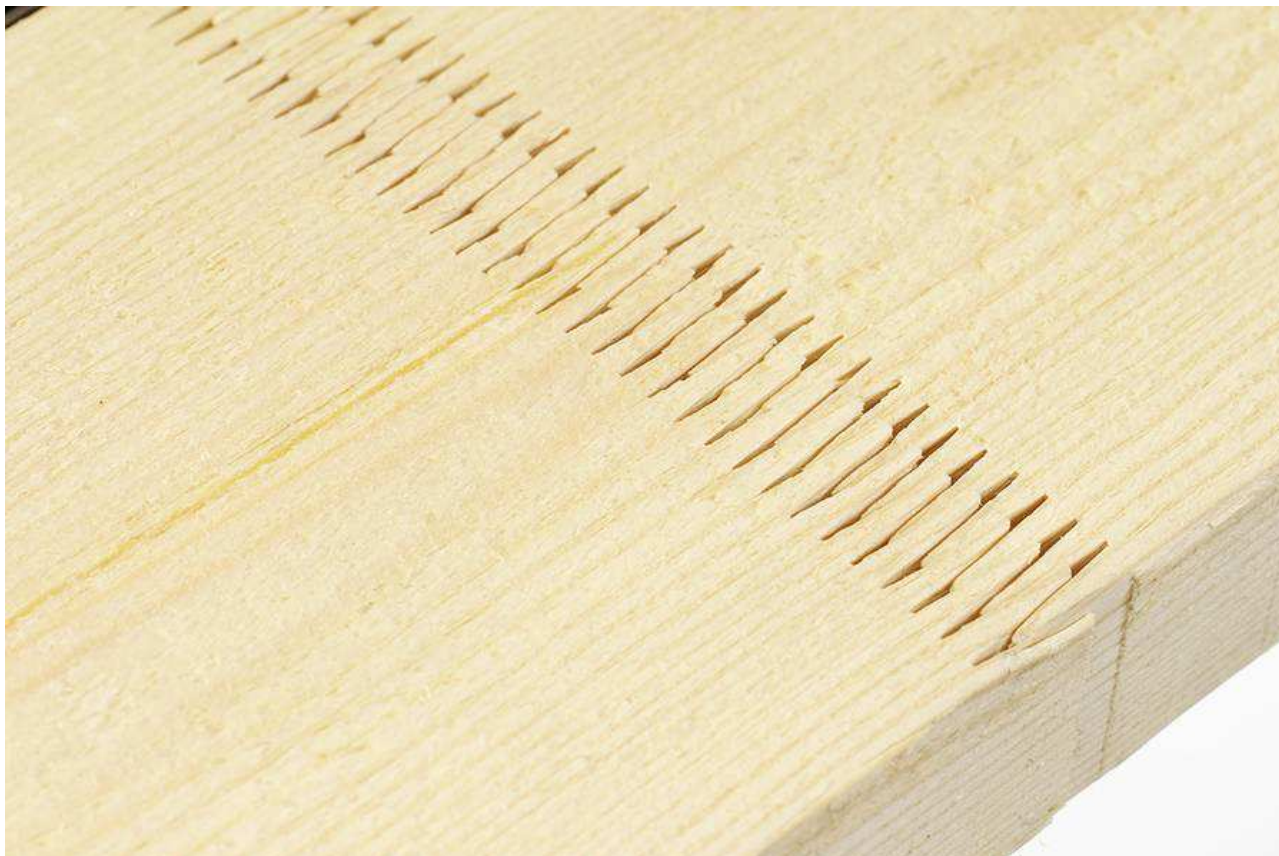
Figura 58: foto di dettaglio del legno massello da costruzione KVH con i caratteristici giunti a pettine
