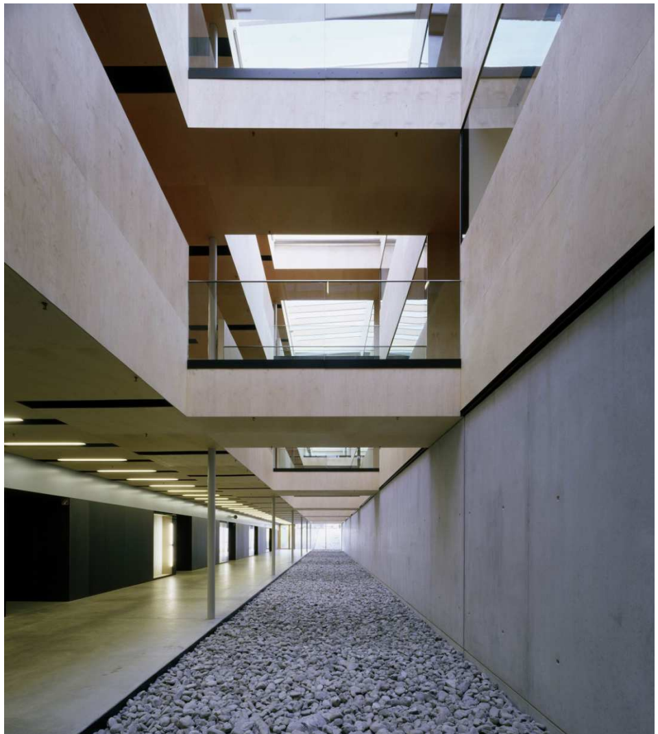
Fig. 258: il lucernario illumina fino all'interrato grazie ad uno spazio a tutta altezza
