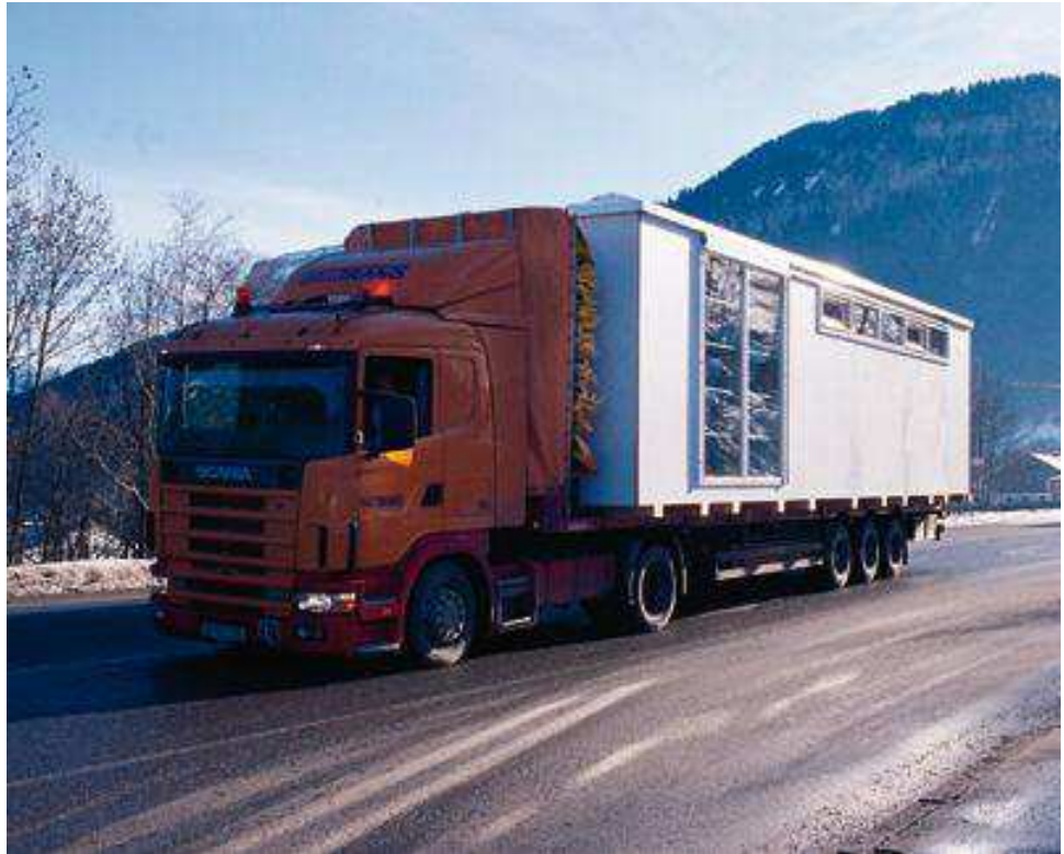
Fig. 203: il modulo abitativo fotografato durante il trasporto via camion
