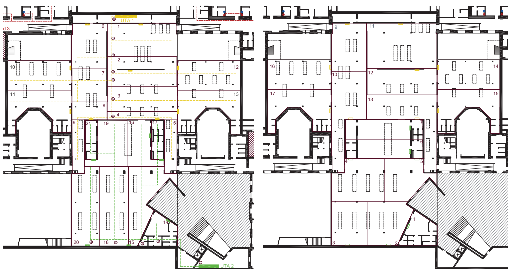
Fig. 16.9. e fig. 16.10. - Schema di suddivisione delle zone di pertinenza dei singoli tubi.
