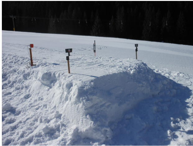
Figura 2.4: Disposizione delle fotocellule sul dente del salto
