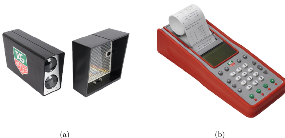
Figura 2.3: Fotocellula ad infrarossi (a) e Chronoprinter 540 (b)
