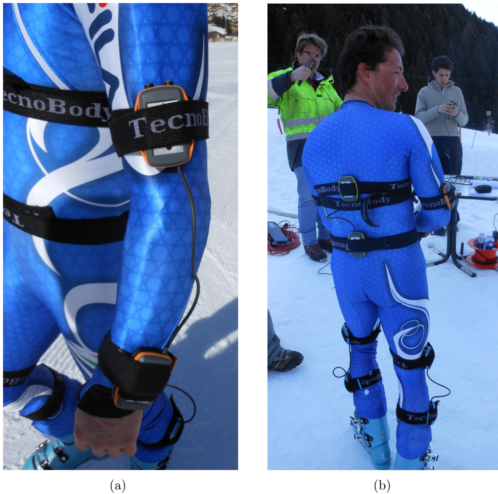
Figura 2.5: Posizionamento dei sensori inerziali TecnoBody
