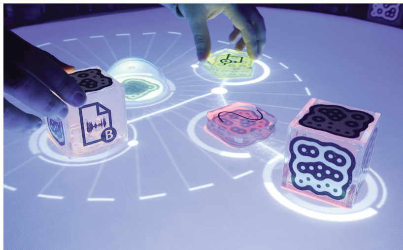
↑ FIGURA 2.4, Reactable è uno strumento musicale elettronico. La peculiarità del progetto risiede nel meccanismo di interazione fra uomo e macchina, basato sull'utilizzo di particolari oggetti e di una superficie touchscreen.
