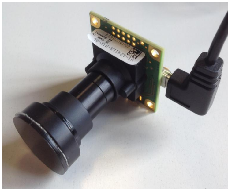
Figura 37 Immagine di una delle due telecamere acquistate. Si può notare la telecamera vera e proprio cui sono collegato i due estensori in serie. sono visibili anche l'ottica della Lensagon e il filtro all'infrarosso montato su essa.
