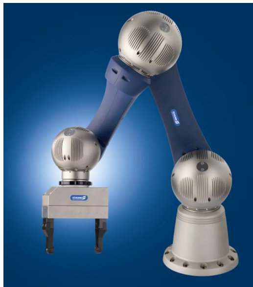
Figura 45 Il PowerBall Arm della Robotnik nella configurazione a sei gradi di libertà. Sono visibili i tre servo-attuatori.
