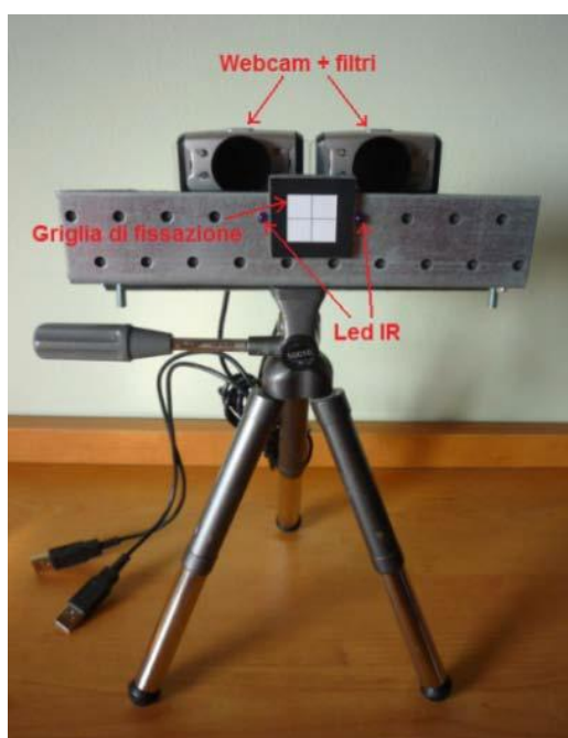
Figura 27 Fotografia del prototipo di eye-tracking realizzato, in cui sono indicati i diversi elementi che lo compongono.
