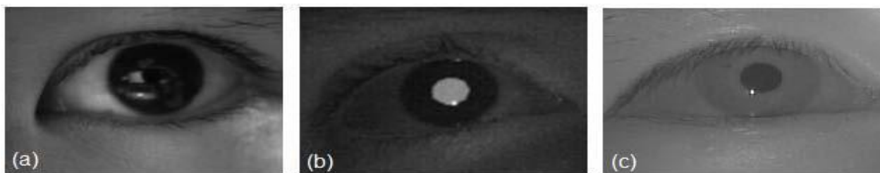
Figura 4 (a) Immagine di un occhio acquisita nello spettro visibile; la parte superiore del limbo è parzialmente coperta dalla palpebra. (b) Immagine di pupilla chiara ottenuta mediante illuminazione infrarossa coassiale con l'asse ottico della telecamera. (c) Immagine di pupilla scura acquisita con una sorgente IR non coassiale. Nelle figure (b) e (c) sono visibili i glint luminosi prodotti dalla riflessione corneale dei raggi IR.
