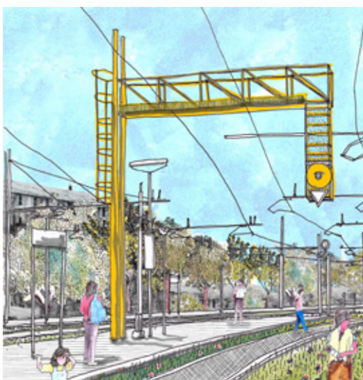
Palo in acciaio Struttura reticolare in acciaio Altezza 850 cm Traliccio supporto per cavi elettrici e semaforo
