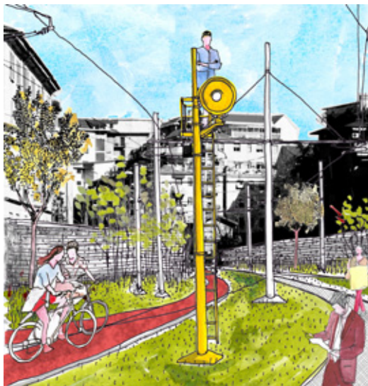
Palo in Acciaio Scaletta in Acciaio Altezza 550 cm Regolazione transito treni
