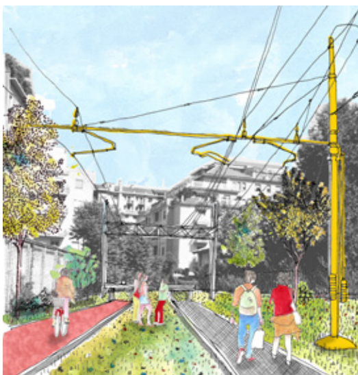
Palo in acciaio Altezza 850 cm Singolo o doppio braccio Supporto cavi elettrici
