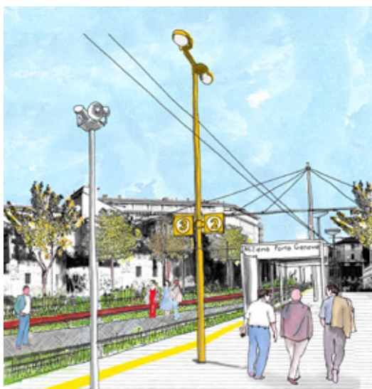
Palo in Acciaio Altezza 550 cm Singola o doppia fonte di illuminazione Illuminazione scalo ferroviario
