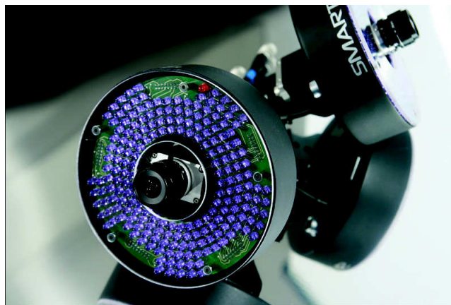
Figura 3.2: Telecamera optoelettronica ad infrarosso.
