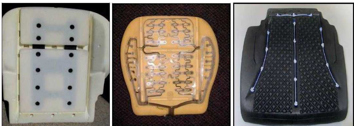
(Fig. 64): Componenti di vario tipo solidali con il pad di poliuretano.
