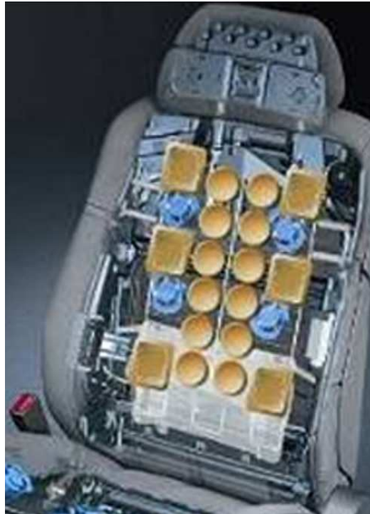
(Fig. 73): In giallo sono evidenziati gli air-bag responsabili della funzione massaggio nello schienale.
