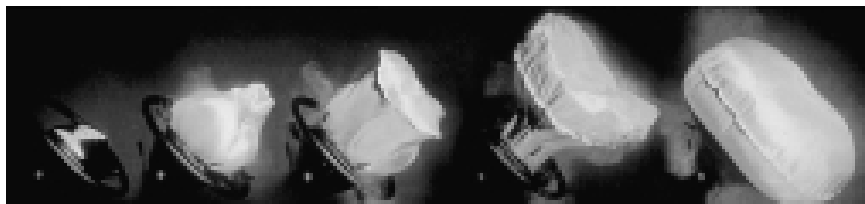
(Fig. 89): Fasi di apertura dell'airbag.
