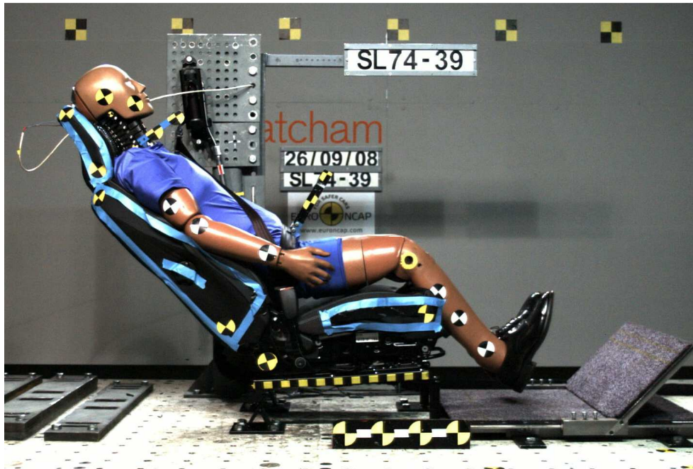
(Fig. 82): Simulazione di un "tamponamento" (Impatto posteriore sul veicolo). Crash-test con manichino per l'analisi dei dati, su un sedile Volvo.
