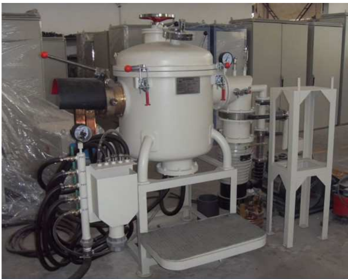
(Fig. 20) Raffigurazione schematica e realistica di un forno per fusione a induzione sottovuoto.
