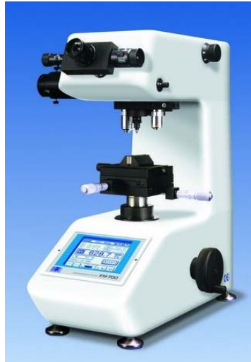
Figura 3.5: Microdurometro FM700 Tecmet®.
