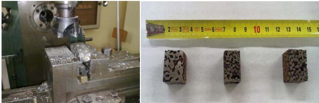
Figura 2.18: Fase di lavorazione: alla fresa nell'immagine sinistra; schiume finite nell'immagine a destra.
