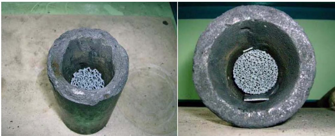
Figura 2.8: Preparazione della lingottiera con la matrice ceramica Vukopor® S.
