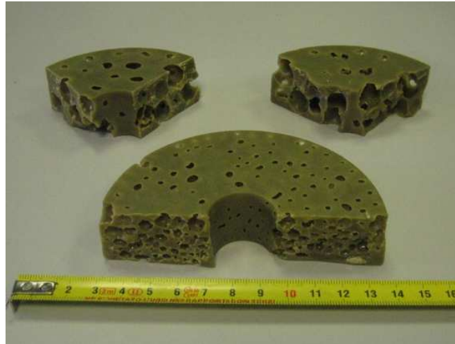
Figura 2.3: Sezione dei modelli in cera delle schiume.
