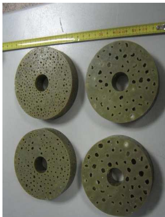
Figura 2.2: Modelli in cera delle schiume.
