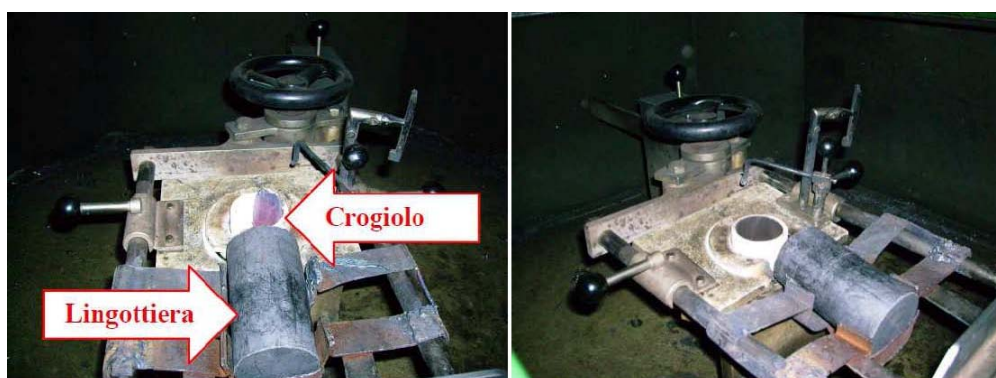
Figura 2.9: Forno elettrico ad induzione utilizzato per la produzione di schiume.
