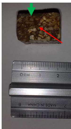
Figura 4.10: Schiuma da 30 PPI: la feccia rossa indica la zona in cui la schiuma si è ripiegata, la freccia verde la direzione di applicazione del carico.
