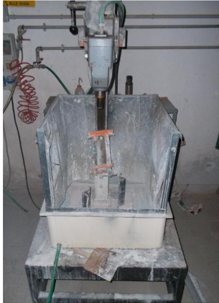
Figura 2.3: Macchina sovracarotatrice
