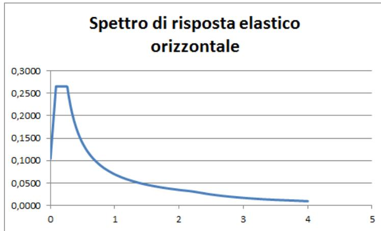
Figura 7.7: Spettro di risposta elastico orizzontale allo SLV per la diga del Fusino
