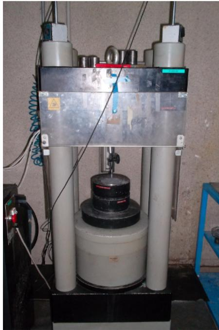
Figura 2.5: Macchina per l'esecuzione delle prove mono/triassiali
