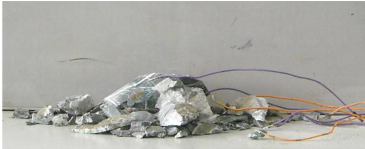
Figura 2.24: Rottura del campione a seguito della prova di compressione monoassiale
