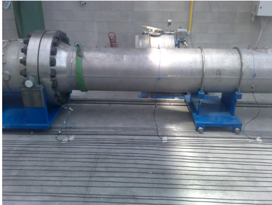
Figura 1.26 - Posizione dei trasduttori dinamici di pressione posti nella camera driven
