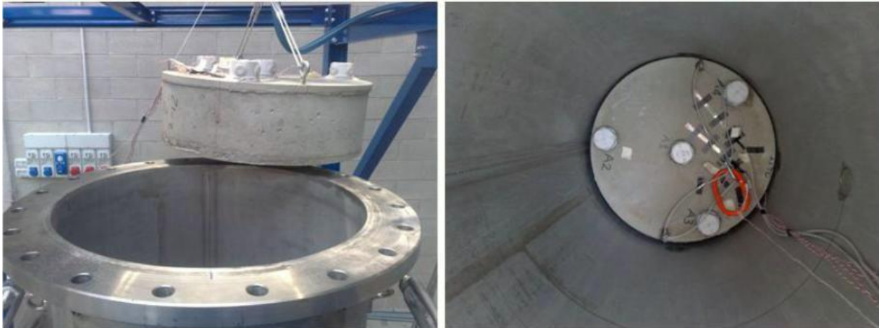
Figura 1.11 - Deposizione del disco di calcestruzzo strumentato all'interno delle camera disco/terreno
