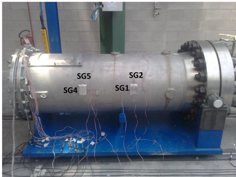
Figura 1.32 - Posizione degli estensimetri circonferenziali e radiali sulla camera disco/terreno
