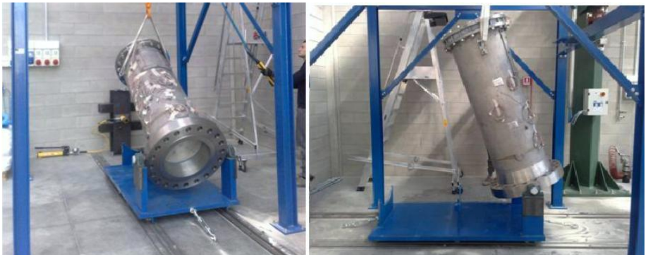
Figura 1.10 - La camera disco/terreno viene disposta in verticale
