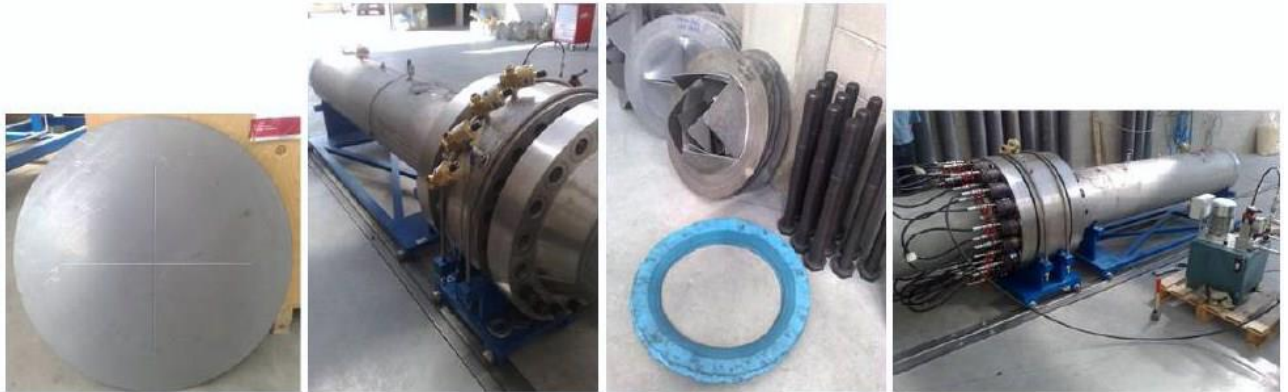
Figura 1.9 - Diaframma in acciaio e fase d'assemblaggio di driver, buffer e driven
