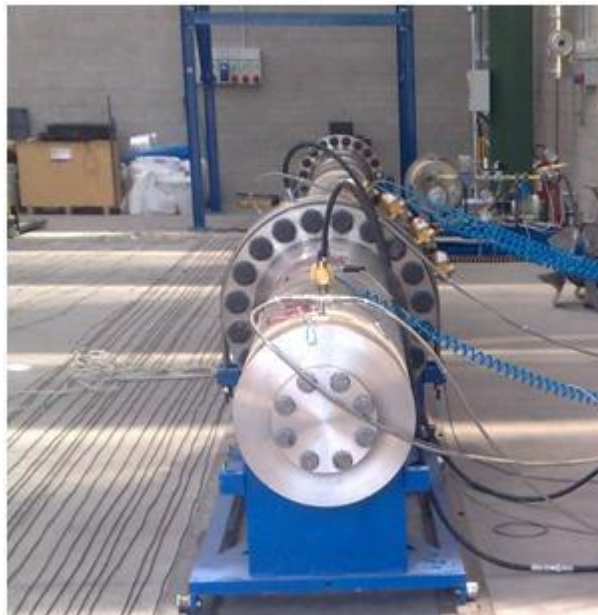
Figura 1.6 - Particolare della flangia cieca del driver
