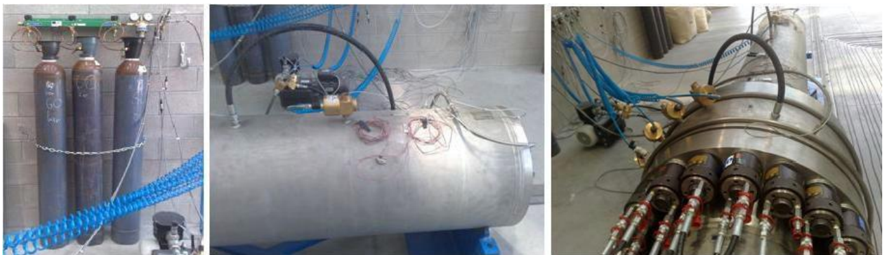
Figura 1.18 - Immissione dell'elio nelle camere buffer e driven
