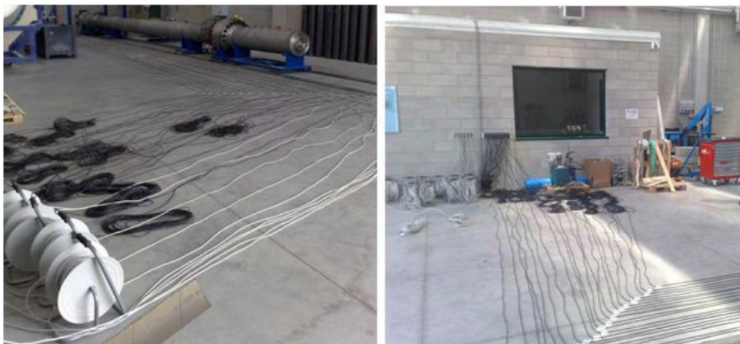
Figura 1.37 - Cavi che collegano lo shock tube con la stazione di controllo
