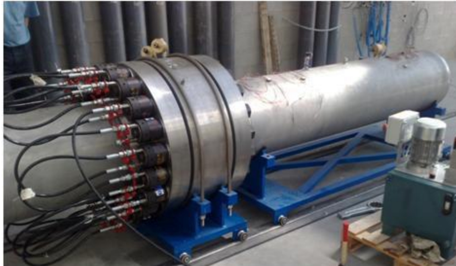
Figura 1.5 - Assemblaggio di driver, buffer e driven
