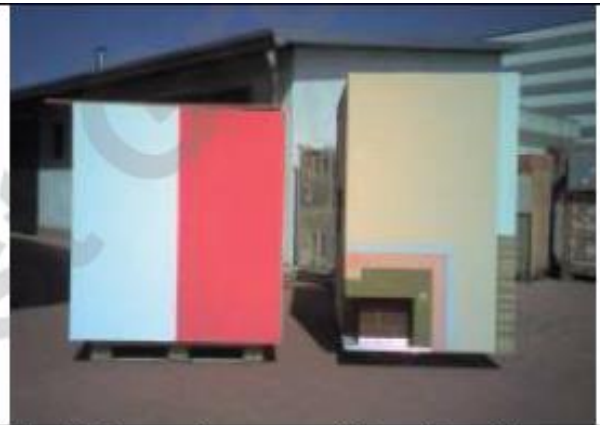
Indagini su manufatto con coefficiente di assorbimento solare medio, chiaro e con struttura in lana di roccia e tasselli senza rondella 04/05/2012
