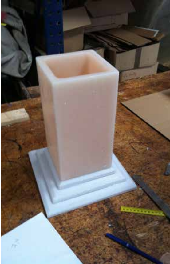
fig.146: prova di montaggio con una lanterna 160x310
