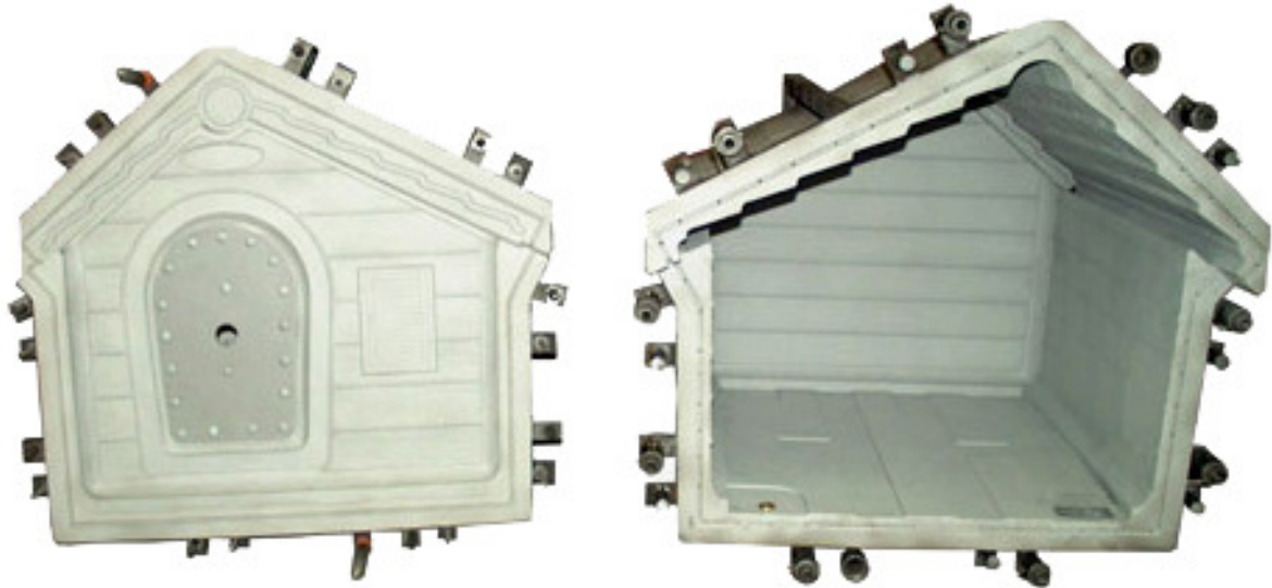
Figura 7. 23 - Stampo con pannello isolante per foratura
