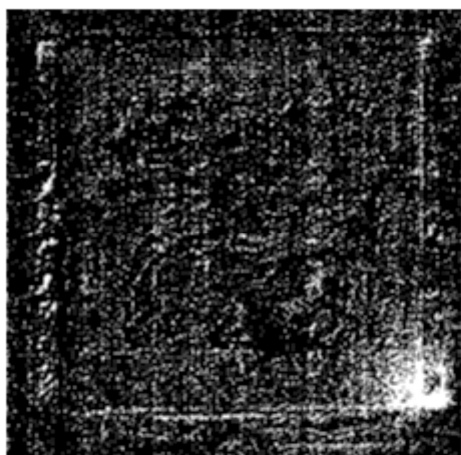
Figura 3.11 – Immagine IR del campione ( c ) di celle tracciate e che hanno subito il fenomeno di Infant Mortality.
