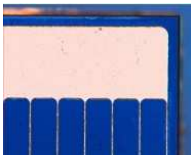
Figura 3.9 – Layout della griglia per prevenire l'effetto di accumulo di carica negli angoli
