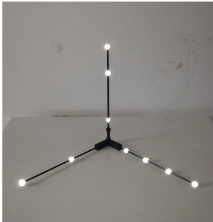
Fig. 2.3: La terna di calibrazione fornita in dotazione da BTS. Le bacchette con i marcatori sono asportabili per permettere la seconda fase della calibrazione.
