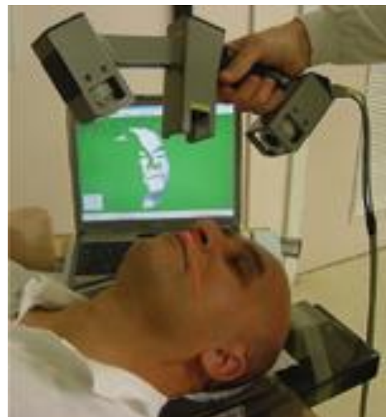
Fig. 1.13: Il sistema di scansione FastSCAN™, modello SCORPION, ed un esempio di possibile applicazione in ambito biomedicale
