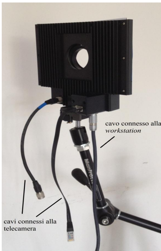
Fig. 4.6: I cavi che connettono la TVC alla work-station , passando dall'illuminatore IR.
