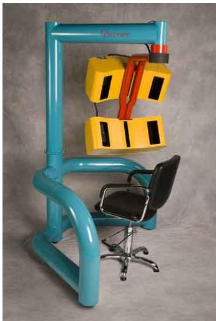
Fig. 1.9: A sinistra il sistema PX ® di Cyberware, a destra un esempio di scannerizzazione dove si può notare la sovrapposizione texture /immagine colorata.
