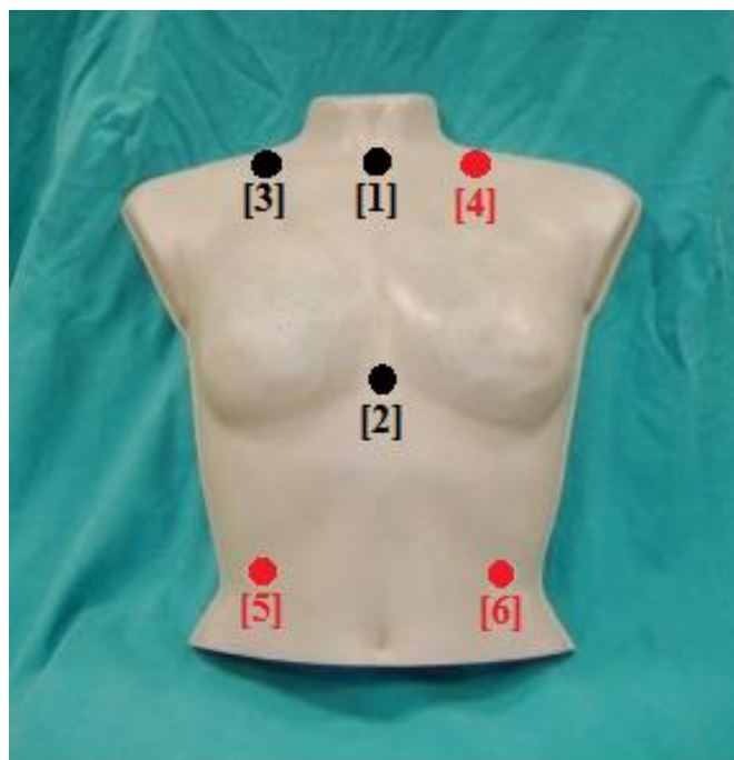
Fig. 2.12: In nero, i 3 marcatori posti sul manichino antropomorfo in posizioni riconoscibili, per le prove sperimentali di compensazione dei movimenti rigidi. In rosso, gli ulteriori 3 marcatori (numero minimo) da porre per le prove su pazienti. [1]: Giugulo; [2]: processo xifoideo; [3-4]: clavicola destra e sinistra. [5-6]: Bordo mediale della gabbia toracica (all'altezza dell'apice inferiore della 10 costola).
