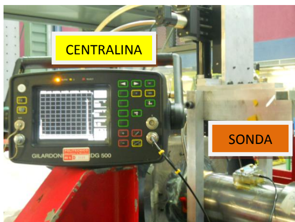
Figura 2.8 Centralina e sensore durante il controllo.
