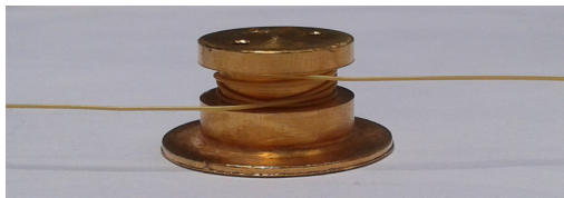
Figura 4.5: Fotografia del cilindretto metallico attorno al quale viene arrotolato il tubo, prima che venga spalmata la pasta termoconduttiva.
