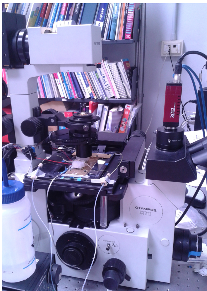
Figura 3.3: Foto del microscopio a fluorescenza invertito utilizzato per la caratterizzazione del dispositivo: sul piatto è montata una piastra appositamente costruita che sostiene il campione e scambia calore tra le celle Peltier e il microscopio.
