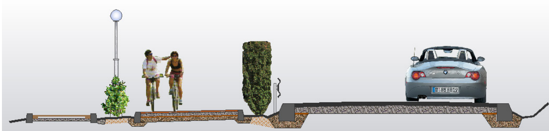
Figura 50 : Sezione "tipo" di strada con percorso ciclopedonale
