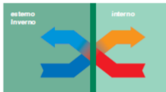
Figura 144 : Funzionamento invernale del recuperatore
