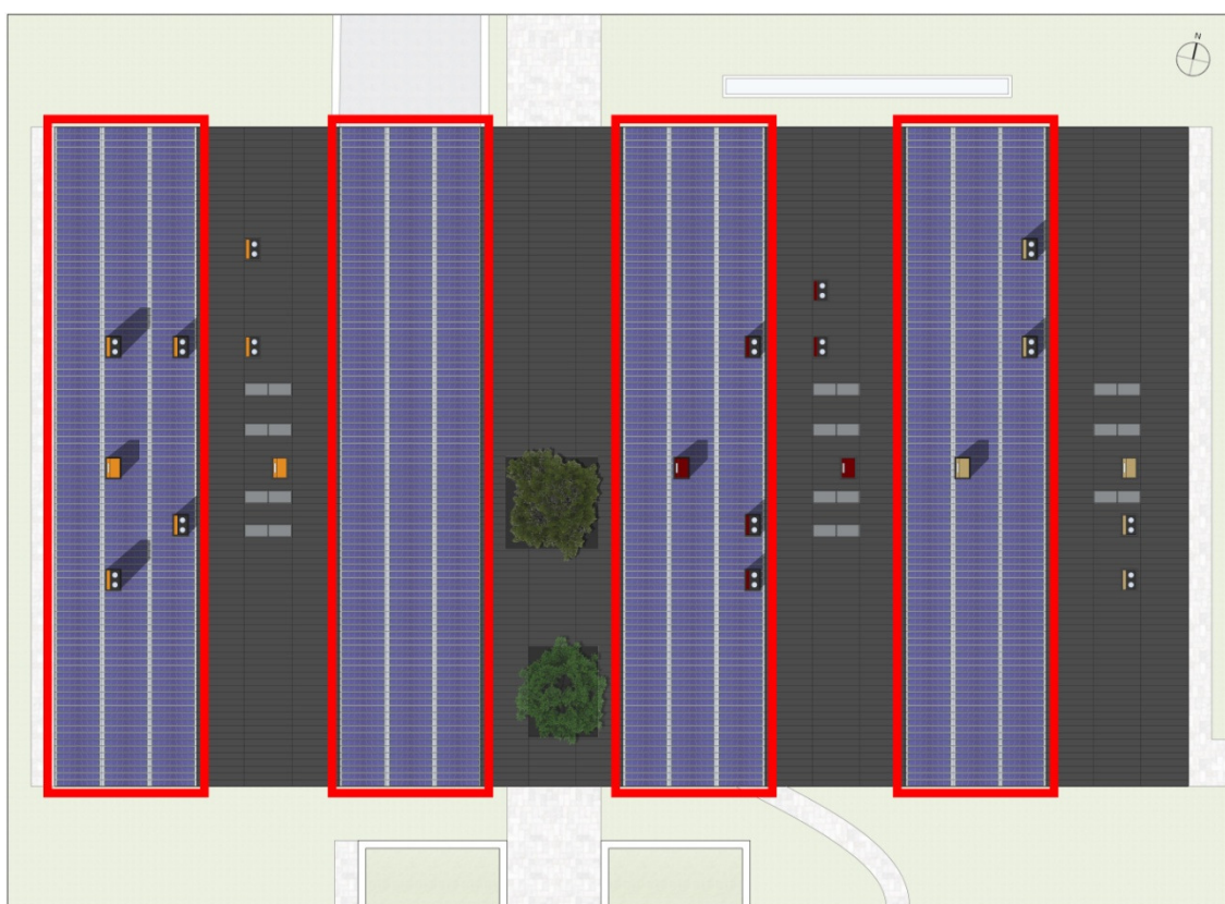
Figura 147 : Distribuzione dei pannelli fotovoltaici sulla copertura
