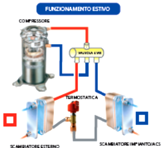
Figura 139 : Funzionamento estivo della pompa
