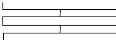
Figura 5.10: Schema della molla per movimenti fuori dal piano.
