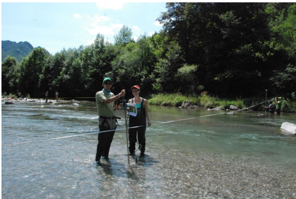
Fig. 3.2 Misure di velocità e profondità in alveo
