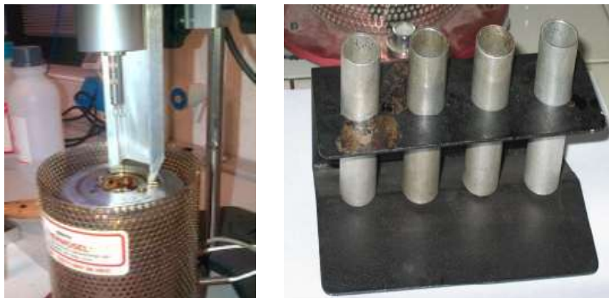
Figura 3.2-9: Dettaglio del posizionamento del campione e dello spindle all'interno del viscosimetro (sinistra); Contenitori del bitume da inserire all'interno del viscosimetro (destra)
