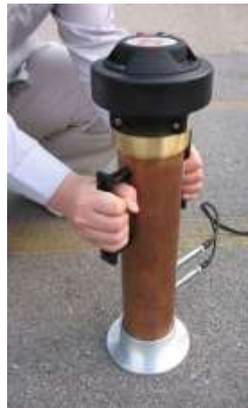
Figura 1.4-11: Rappresentazione del Tubo di Kundt Portatile
