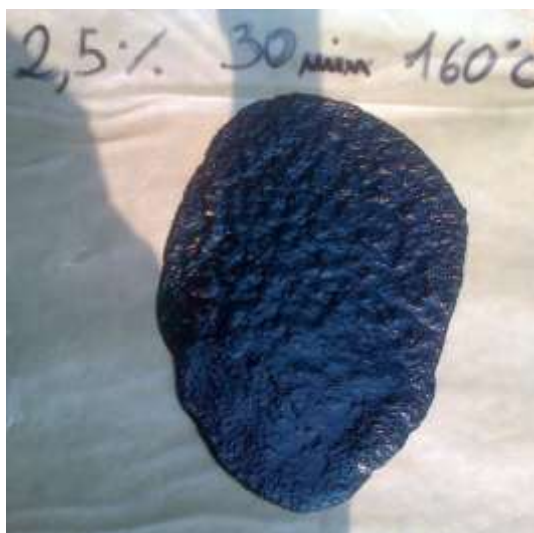
Figura 4.2-1: Aspetto del bitume miscelato direttamente con il Compound
