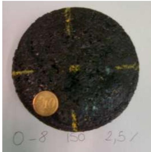
Figura 5.4-1: Rappresentazione di un campione del conglomerato 0 – 8 contenente il 2,5% di Compound
