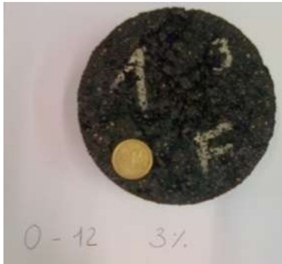
Figura 5.2-5: Rappresentazione di un campione del conglomerato contenente il 3% di Compound
