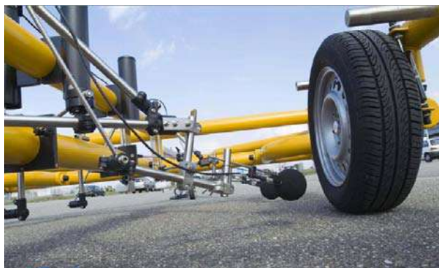
Figura 1.4-6: Collocazione del microfono nel caso in cui si utilizzi un apposito trailer per effettuare il CPX
