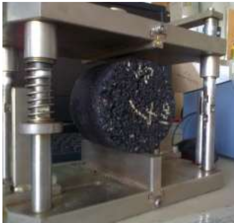
Figura 5.1-14: Collocazione del campione tra le bande di carico
