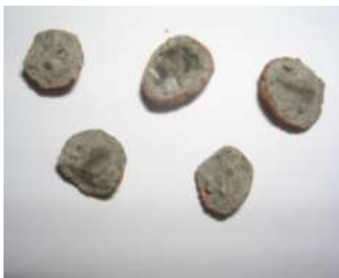
Figura 2.5-1: Dettaglio dell'aggregato di argilla espansa frantumato
