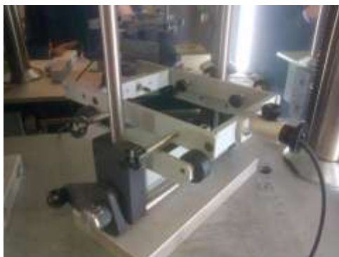
Figura 5.1-16: Castello dove collocare il campione prima di effettuare la prova (sinistra); Campione collocato nel castello tra le bande di carico (destra)
