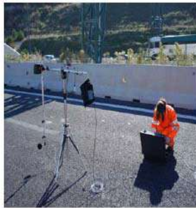
Figura 1.4-3: Rappresentazione della strumentazione utilizzata nel Metodo Adrienne
