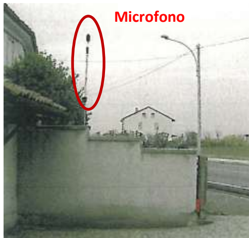
Figura 6.2-1: Collocazione del microfono utilizzato per i rilievi fonometrici
