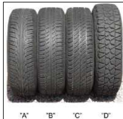
Figura 1.4-7: Tipologie di pneumatico da utilizzare nel CPX secondo Normativa
