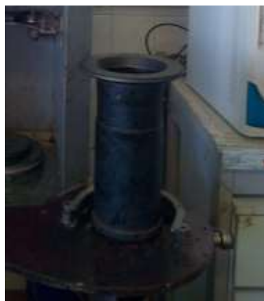
Figura 5.1-6: Fustella all'interno della quale viene compattato il campione di conglomerato
