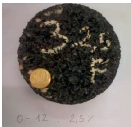
Figura 5.2-4: Rappresentazione di un campione del conglomerato contenente il 2,5% di Compound
