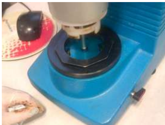
Figura 4.4-8: Dettaglio del posizionamento del bitume e del piatto di carico nel DSR
