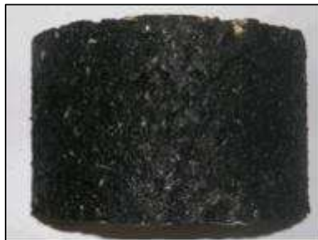
Figura 2.5-4: Provino di conglomerato contenente polverino di gomma tipo gap-graded
