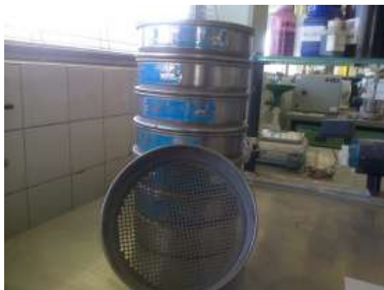
Figura 3.1-5: Setacci di prova con apertura delle maglie di dimensione normata
