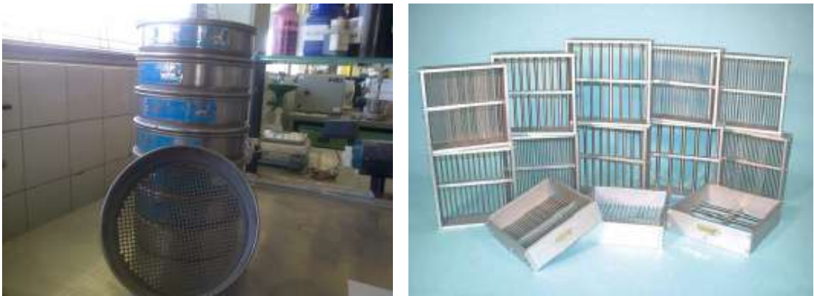
Figura 3.1-15: Tipologie di setacci utilizzati per determinare l'indice di forma: Setacci a maglie quadrate (sinistra); Setacci a barre (destra)
