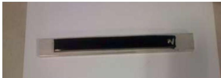
Figura 4.4-14: Campione di bitume da sottoporre a BBR Test
