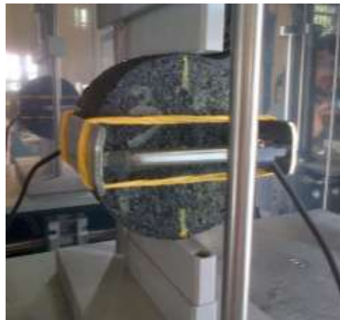
Figura 5.1-19: Posizionamento degli estensimetri per misurare la deformazione laterale del campione
