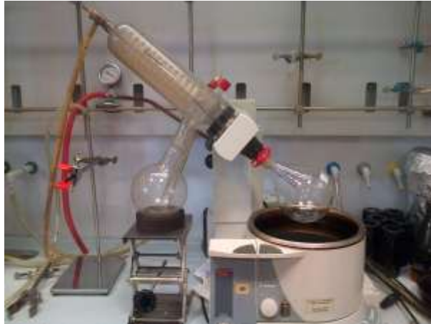
Figura 4.2-4: Evaporatore rotante utilizzato per la separazione del bitume dal solvente
