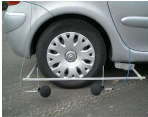
Figura 1.4-5: Collocazione del microfono nel caso in cui si utilizzi una vettura per effettuare il CPX
