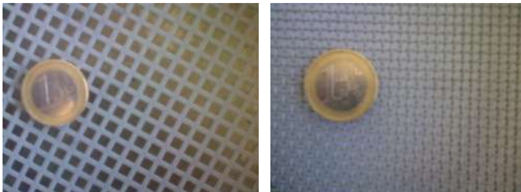
Figura 3.1-6: Esempio di setacci con aperture in lamiera perforata (sinistra) o in rete metallica (destra)
