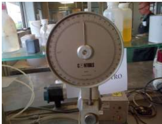
Figura 3.2-3: Dettaglio del misuratore della penetrazione
