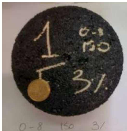
Figura 5.4-2: Rappresentazione di un campione del conglomerato 0 – 8 contenente il 3% di Compound
