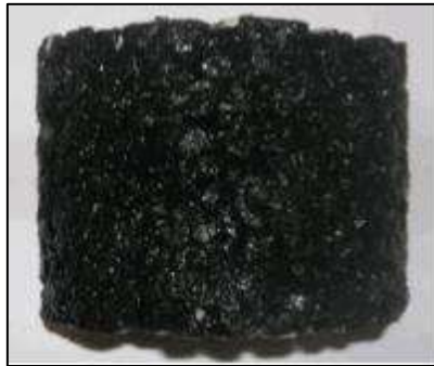
Figura 2.5-3: Provino di conglomerato contenente polverino di gomma tipo open-graded
