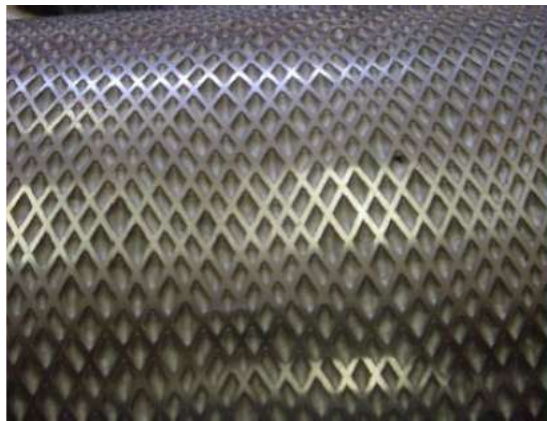
Figura 2.5-6: Dettaglio del rullo utilizzato per stampare la tessitura sulla pavimentazione
