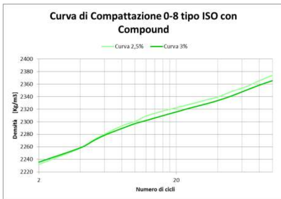
Figura 5.4-7: Confronto curve di compattazioni miscela 0 - 12 con 2,5% e 3% di Compound
