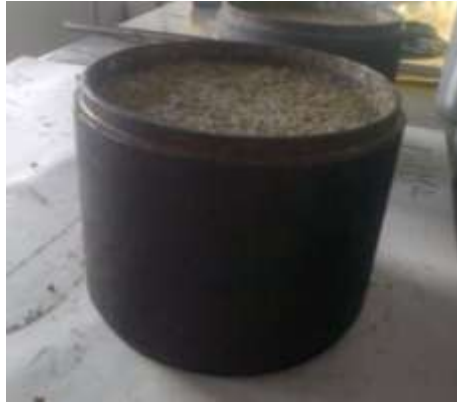
Figura 5.1-4: Campione Marshall lasciato raffreddare nello stampo
