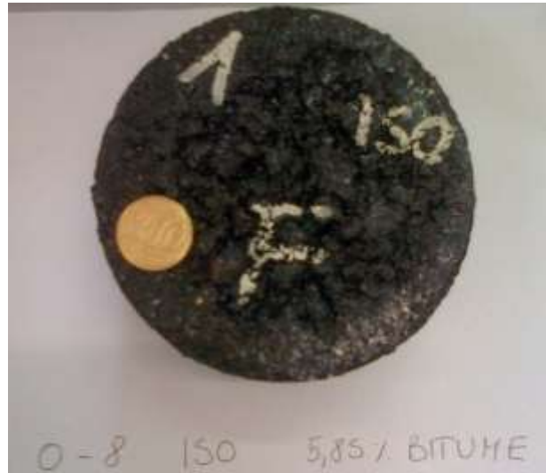
Figura 5.3-5: Rappresentazione di un campione del conglomerato 0 – 8 tipo ISO 10844
