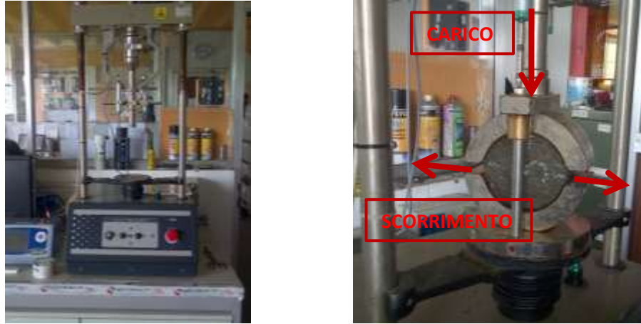
Figura 5.1-12: Macchinario di prova per effettuare il carico alla corretta velocità (sinistra); Dettaglio del campione caricato (destra)
