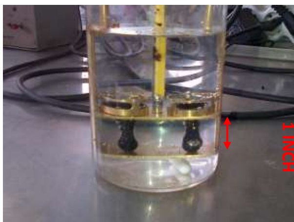
Figura 3.2-7: Condizione di termine della prova palla - anello
