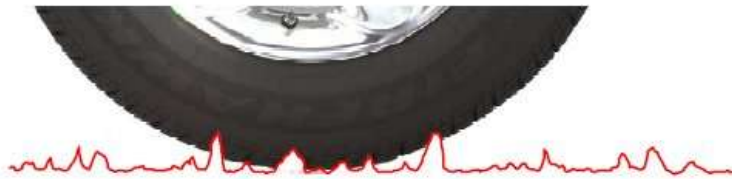
Figura 2.1-7: Esempio di tessitura POSITIVA
