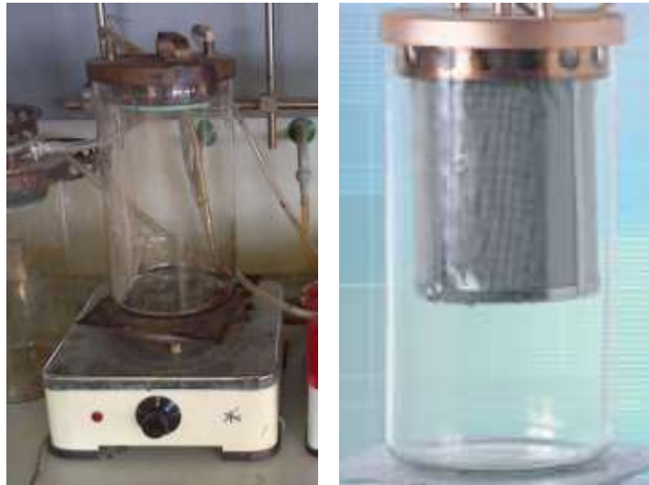
Figura 4.2-2: Estrattore per la rimozione del bitume dal conglomerato tramite solvente (sinistra); Dettaglio del contenitore per il conglomerato (destra)
