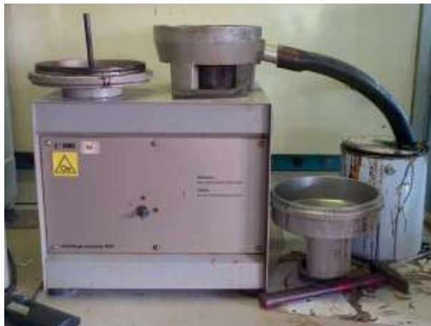
Figura 4.2-3: Centrifuga a flusso continuo utilizzata per la separazione del filler dalla miscela bitume - solvente
