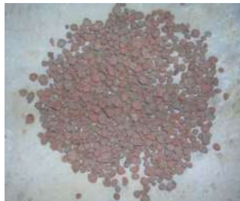
Figura 2.5-2: Argilla espansa utilizzata all'interno del conglomerato per la riduzione del rumore
