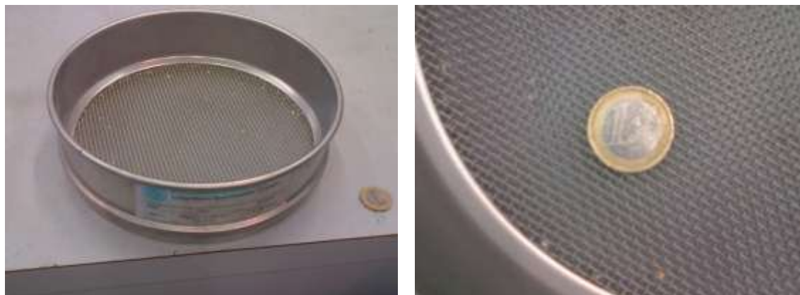
Figura 3.1-19: Setaccio con apertura delle maglie 1,6 mm utilizzato nella prova Los Angeles
