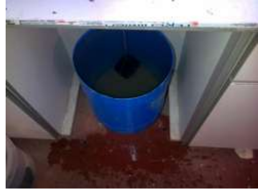
Figura 5.1-10: Rappresentazione della misura del peso del campione in acqua
