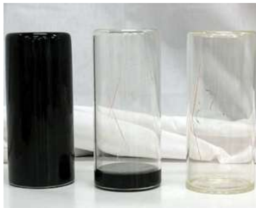
Figura 3.2-12: Dettaglio del contenitore del bitume da posizionare all'interno della stufa
