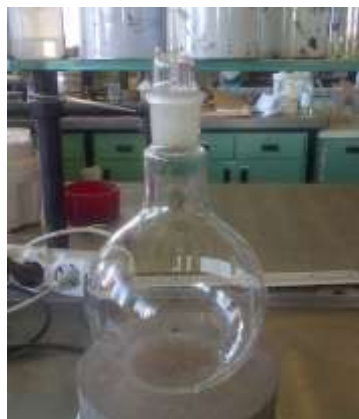
Figura 3.1-12: Picnometro utilizzato per il calcolo del peso specifico
