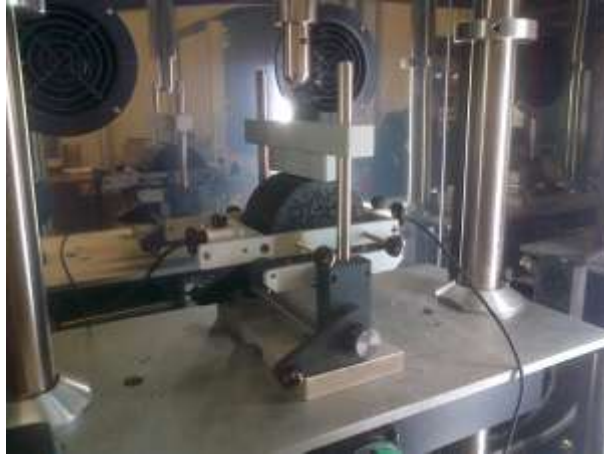
Figura 5.1-17: Collocazione del provino sotto il pistone di carico
