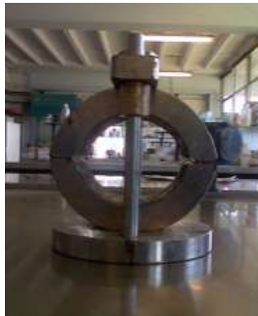
Figura 5.1-11: Ganasce all'interno delle quali si posiziona il provino per effettuare il Marshall Test
