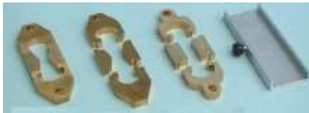
Figura 4.3-6: Stampi per realizzare il campione di bitume da sottoporre alla prova di ritorno elastico
