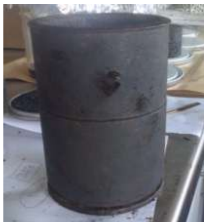
Figura 5.1-2: Stampo cilindrico utilizzato per la compattazione Marshall
