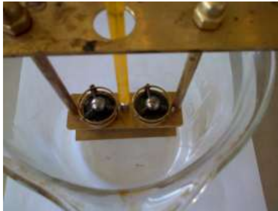
Figura 3.2-6: Posizionamento delle biglie sul campione di bitume da analizzare
