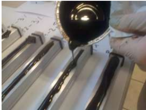
Figura 4.4-13: Realizzazione del provino di bitume da sottoporre a BBR Test
