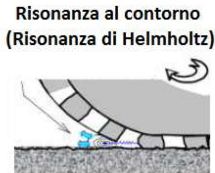
Figura 1.3-16: Rappresentazione del fenomeno noto come Risonanza di Helmholtz
