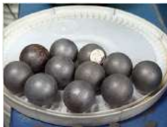
Figura 3.1-18: Dettaglio delle sfere utilizzate nella prova Los Angeles
