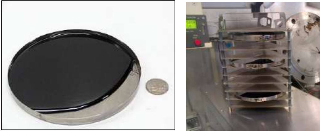
Figura 4.4-2: Contenitore del bitume da inserire all'interno del PAV (sinistra); Castello porta contenitori (destra)
