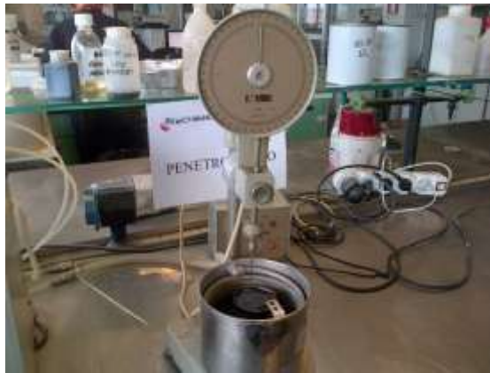
Figura 3.2-1: Penetrometro utilizzato per effettuare la prova di penetrazione con ago
