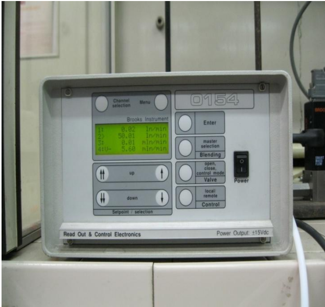
Figura 8 Interfaccia di controllo e flussimetro per la regolazione della portata di aria
