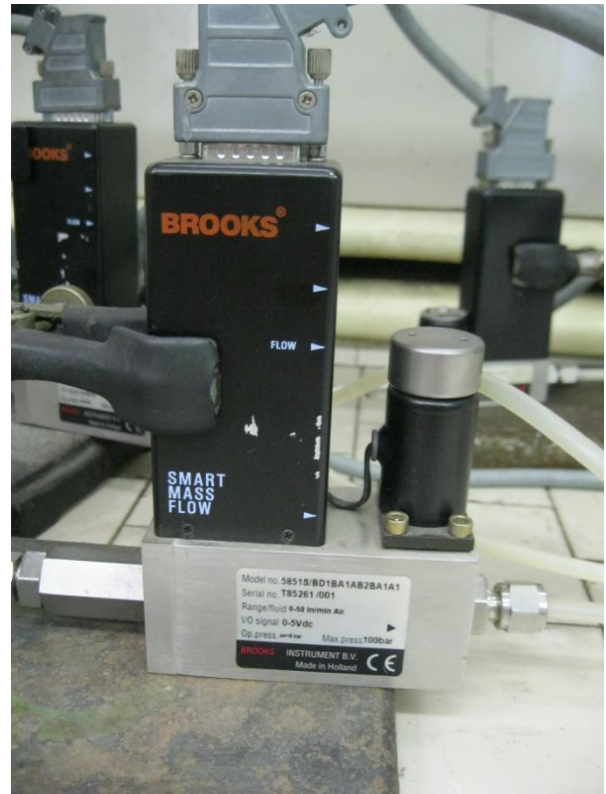
Figura 8 Interfaccia di controllo e flussimetro per la regolazione della portata di aria
