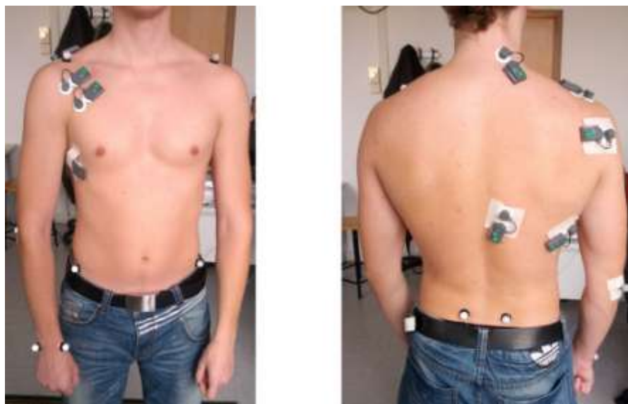
Figura 74: Disposizione degli elettrodi e dei marker sul soggetto.
