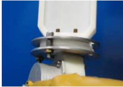
Figura 39: Giunto di frizione del gomito.
