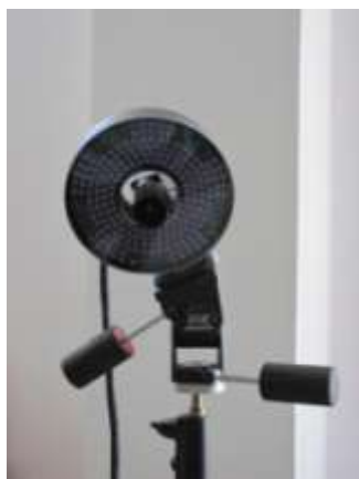
Figura 69: Telecamera del sistema SMART-e (BTS).
