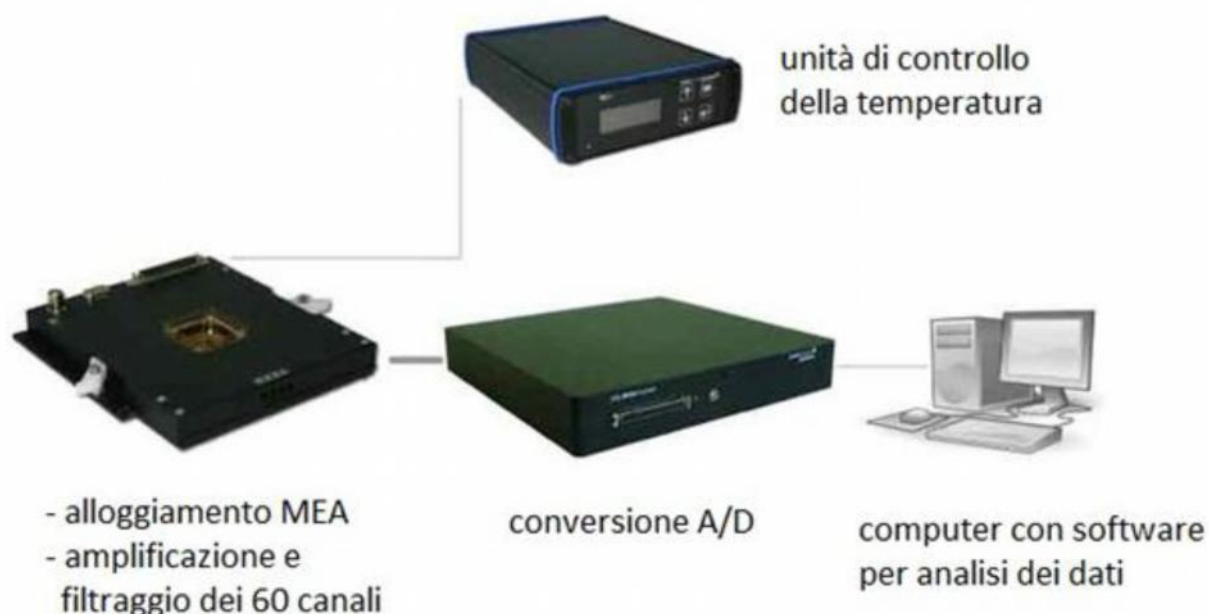
Figura 3. Sistema commerciale USB-MEA1060 (Multi Channel Systems GmbH), per amplificare, filtrare e convertire in digitale i segnali dai 60 canali di un MEA, controllando anche la temperatura delle cellule durante le registrazioni. Il sistema include anche un software per una preliminare analisi dei dati.
