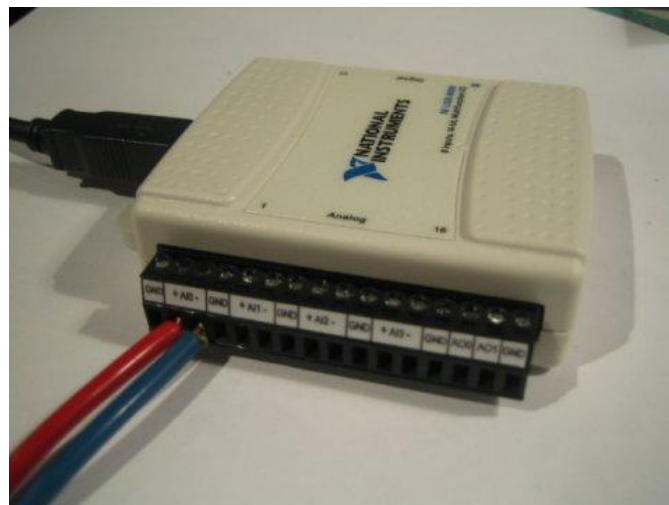
Figura 2.1. Scheda di acquisizione NI USB-6009 a 8 input analogici (14-bit, 48 kS/s)
