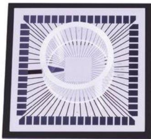
Figura 4.1. Microelectrode array (MEA) utilizzato per registrare l'attività delle colture neuronali. A sinistra: MEA 200-30-iR-Ti-gr (MCS), con elettrodi in nitruro di titanio (TiN), isolante in nitruro di silicio (SiN), pad di contatto e piste in titanio (Ti) ed elettrodo di riferimento interno (evidenziato in nero a sinistra). A destra: layout del MEA, con 60 elettrodi, disposti in una griglia 8x8; distanza tra gli elettrodi: 200 \mu\text{m} ; diametro degli elettrodi: 30 \mu\text{m} .
