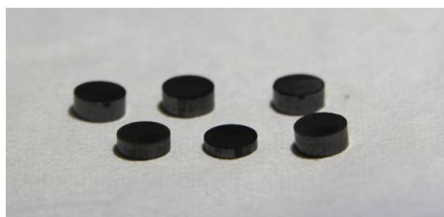
Figura 2: Pastiglie di \text{UO}_2 nanocristallino.
