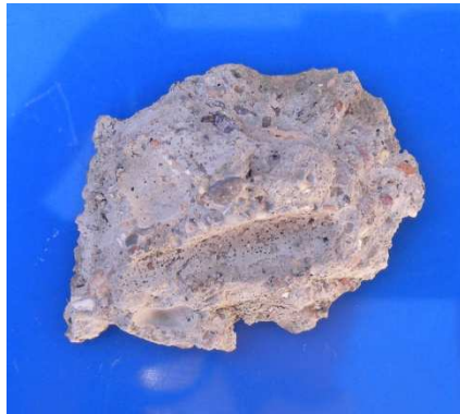
Figura B.12: Prova alla fenolftaleina sulla superficie di rottura del frammento 1-TD-2.
