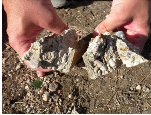
Figura B.10: Prova alla fenolftaleina sulle superfici di rottura del frammento 1-PD-2.
