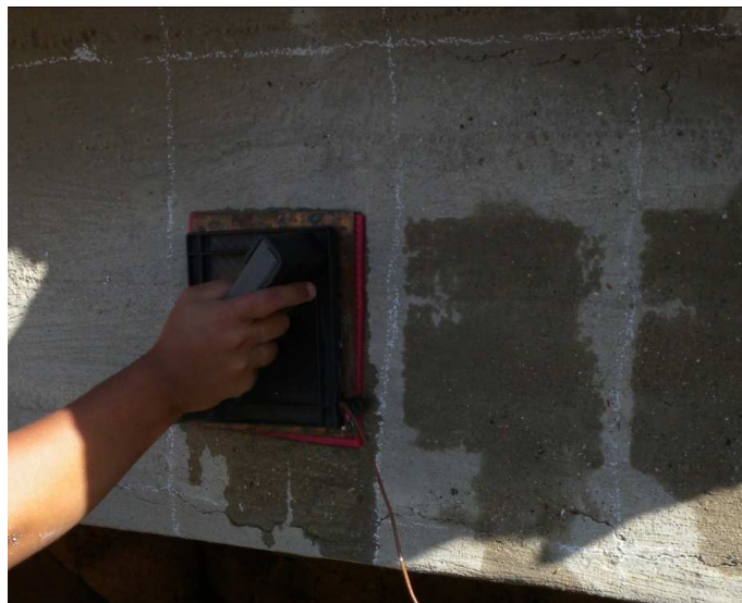
Figura 3.2: Misura della conduttanza in situ tra la faccia nord-ovest e sud-est della trave D della zona 1.
