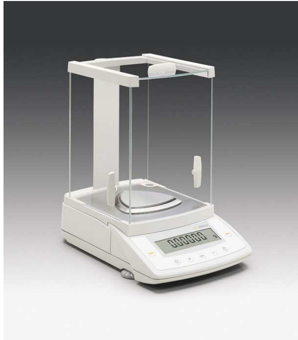
Figura 1. 18: Bilancia analitica a 5 cifre decimali usata per la misura del peso dei pellets.
