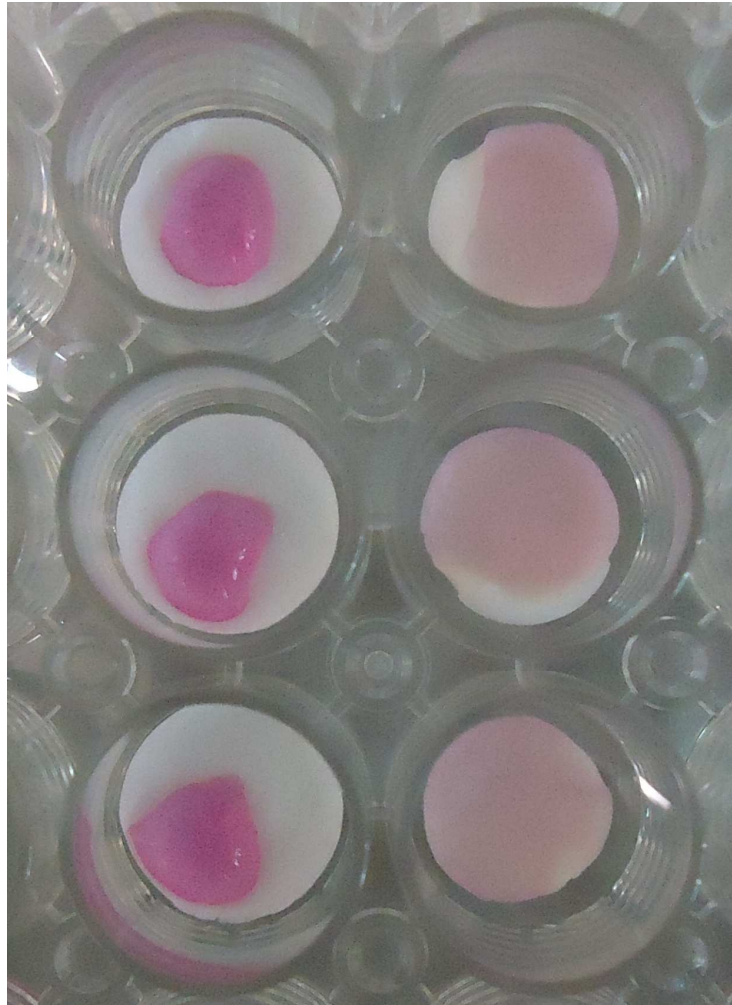
Figura 1. 9: Effetto del trattamento al plasma: colonna di sinistra = scaffold non trattati; colonna di destra = scaffold trattati.
