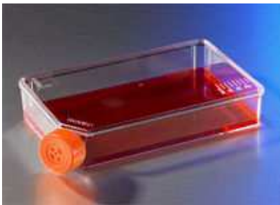
Figura I. 3: Piastra flask per la coltura di cellule ancoraggio dipendenti.
