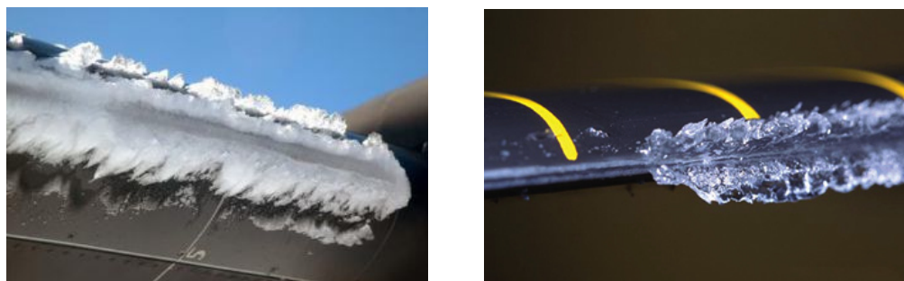
Figura 1.2: Esempi di formazione di ghiaccio rime, a sinistra, e glaze, a destra
