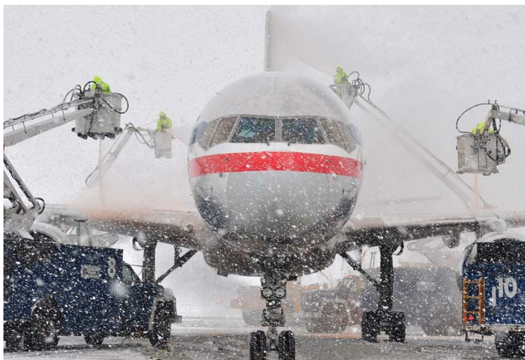
Figura 1.3: Esempio di sistema anti-icing: schiuma
