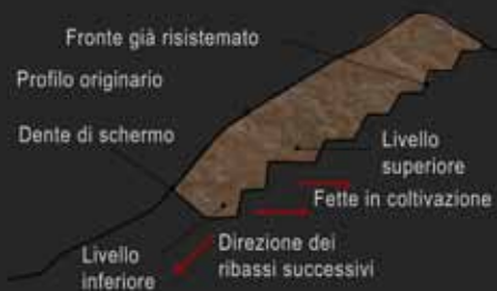
A_ COLTIVAZIONI A GRADONI PER FETTE ORIZZONTALI DISCENDENTI SU PIÙ LIVELLI (DI MONTE E DI PIANURA)
