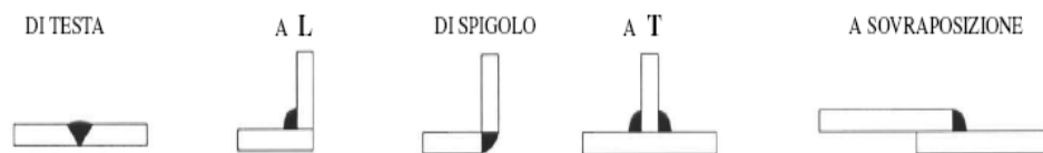
Figura 3: tipi di giunto
